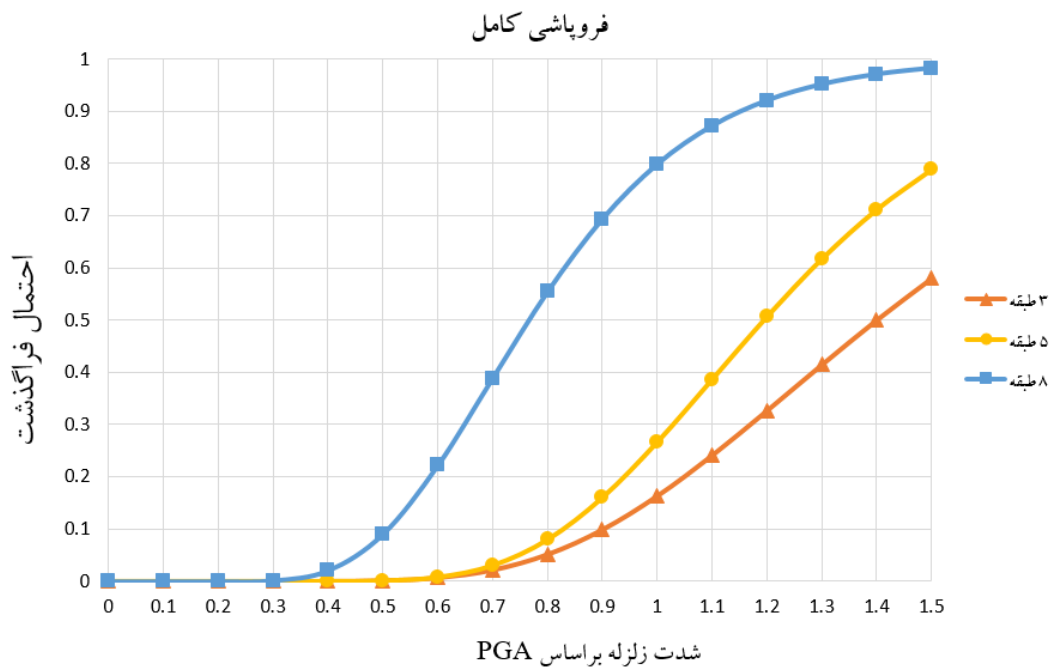
شکل ۴-۱۳. منحنی شکنندگی ساختمان‌های ۳، ۵ و ۸ طبقه با قاب‌های خمشی متوسط RCS در سطح خرابی کامل
