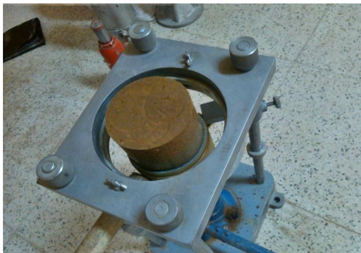
شکل (۳-۵) - خارج کردن خاک متراکم شده از قالب تراکم استاندارد بوسیله ی جک هیدرولیکی
