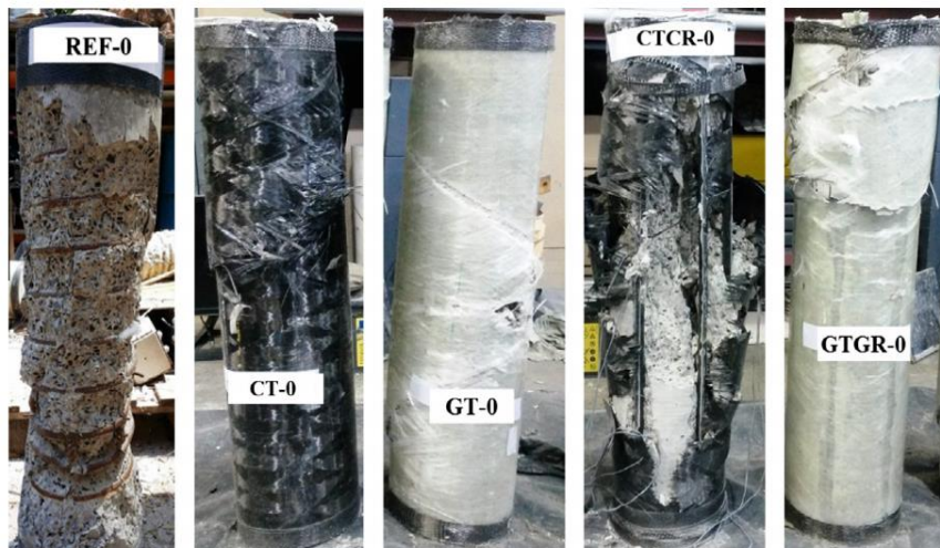
شکل ۲-۶: نمونه‌های آزمایش شده تحت بارگذاری در مرکز سطح مقطع [۱۴]
