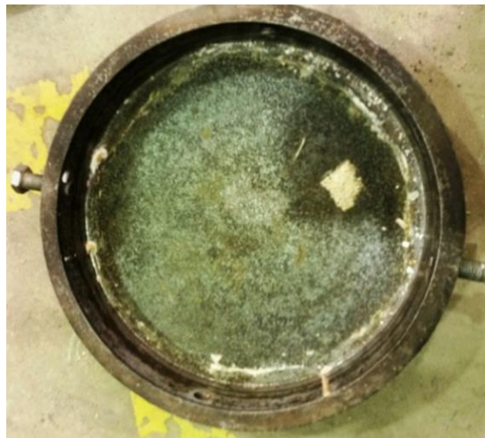
شکل ۲-۴: قالب نمونه‌های CFPT و صفحه انتقال نیرو [۱۴]
