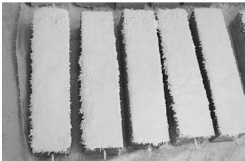
شکل ۱۹.۲: اعمال SFRP به تیرها در آزمایش هاووسمن و همکارش [۳۰]
