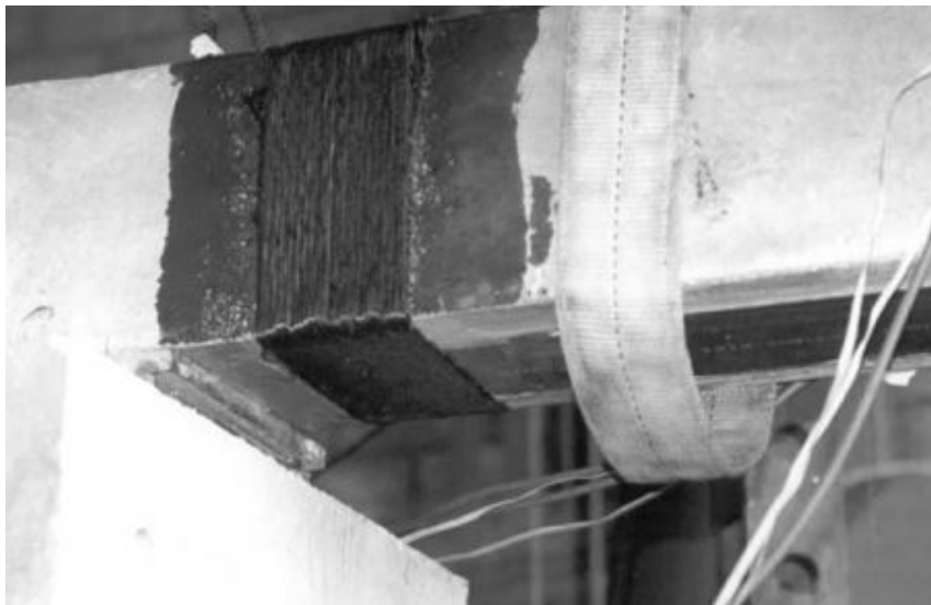
شکل ۱۴.۲: گوشه مقاومسازی شده با دورپیچ در آزمایش رابینوویچ و همکارش [۲۷]
