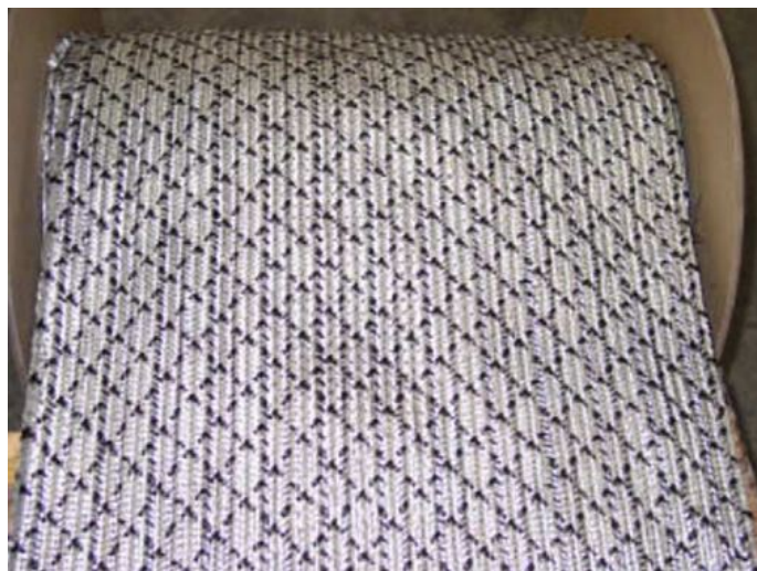
شکل ۱۷.۲: الیاف به هم بافته شده طراحی شده توسط نابیل و همکاران [۲۹]
