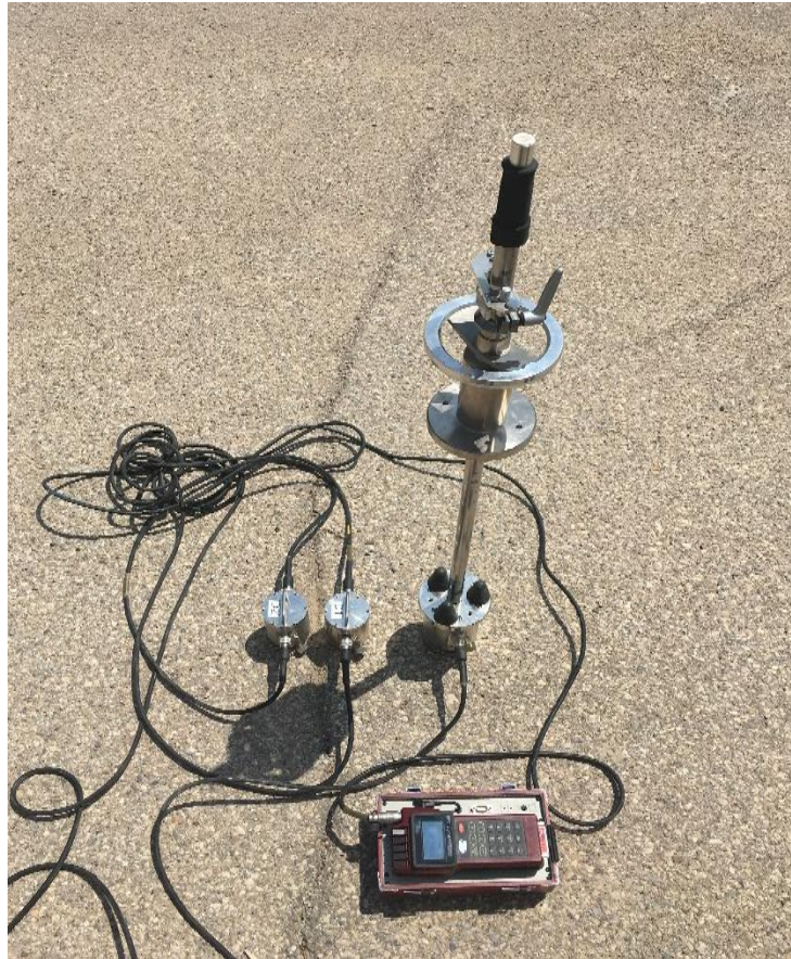
شکل ۳-۴ موقعیت ژئوفون‌ها در روش‌های پیشین اندازه‌گیری LTE
