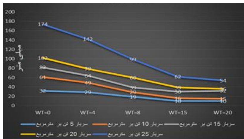
شکل (۴-۶) روند تغییرات نشست در زلزله‌ی السنترو
