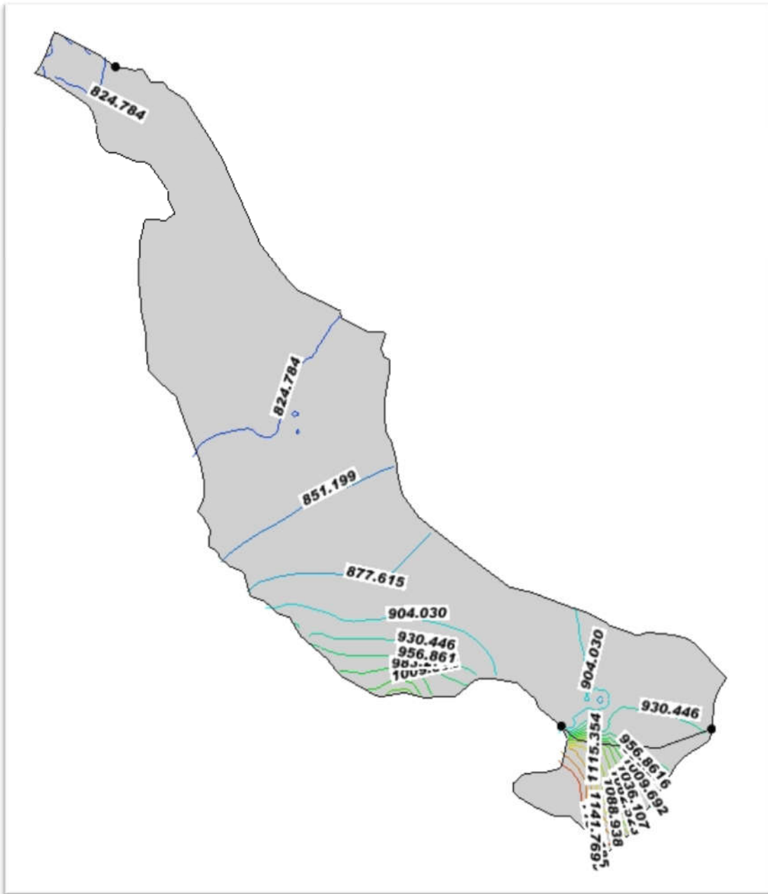
شکل ۴-۲۲ سطح آب زیرزمینی در طول دوره آبی تحت سناریو B2 (آینده دور تا ۲۰۹۹)
