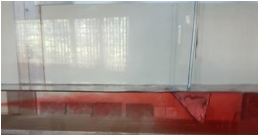
شکل ۳-۱۲۳- تزریق بر جسم گوه در دبی ۱۰۰۰۰ لیتر بر ساعت و عمق ۸ سانتی متر
