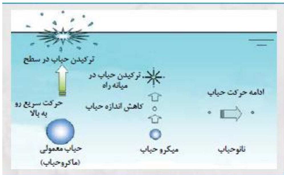
شکل ۲-۱- رفتار متفاوت ماکرو حباب، میکرو حباب و نانو حباب
