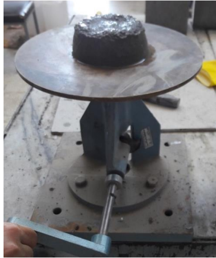
شکل ۳-۵- نمایش از میز جریان برای آزمایش جریان ملات سیمان
