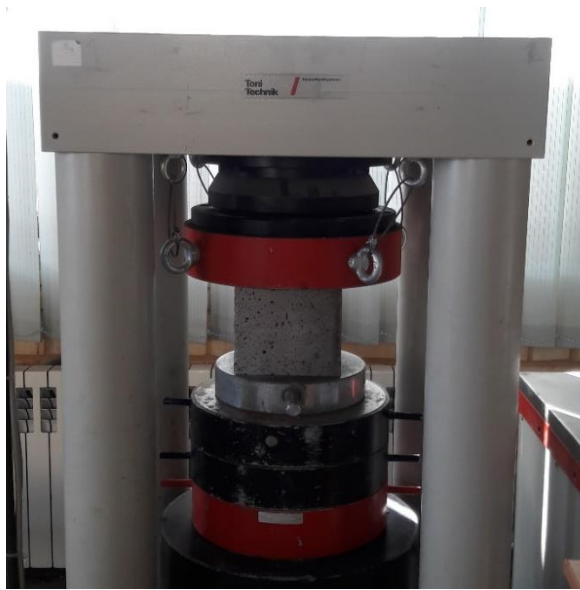
شکل ۳-۱۲- نمونه بتن زیر جک هیدرولیکی برای آزمایش مقاومت فشاری بتن
