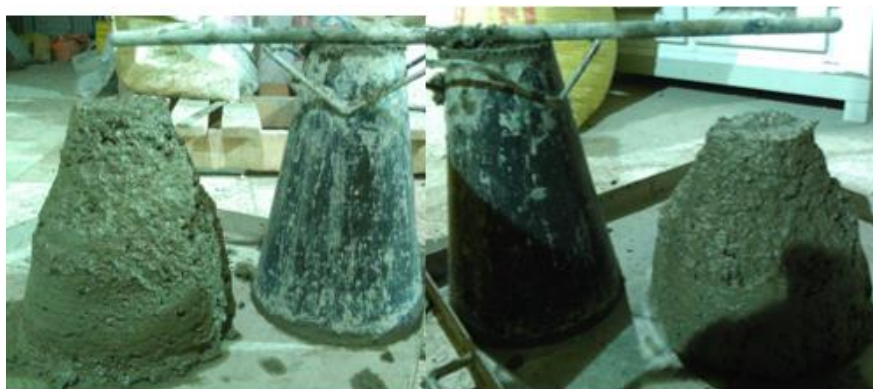
شکل ۳-۸- آزمایش اسلامپ برای بتن حاوی MNB (سمت چپ) و بتن حاوی آب (سمت راست)
