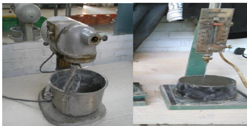
شکل ۳-۴- دستگاه ویکات (عکس سمت راست) و دستگاه مخلوط کن (عکس سمت چپ)
