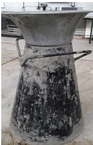
شکل ۳-۹- نمای از مخروط ناقص برای آزمایش اسلامپ
