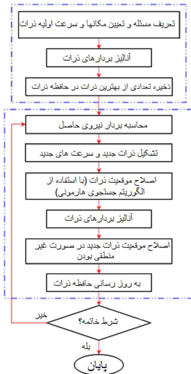
شکل (۳-۲) فلوجارت الگوریتم بهینه‌یابی جستجوی ذرات باردار مبتنی بر شبه کد ارائه شده
