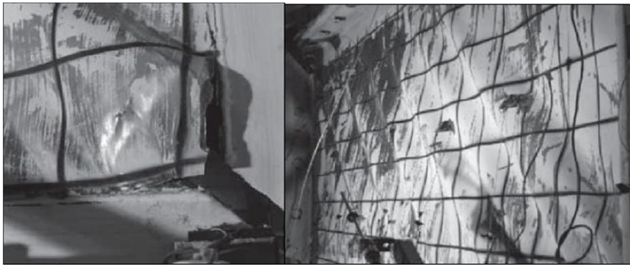
شکل ۲-۴۰- کمانش ورق در دریفت ۱/۸۲ درصد و پارگی ورق در دریفت ۳/۰۷ درصد [۱۶]
