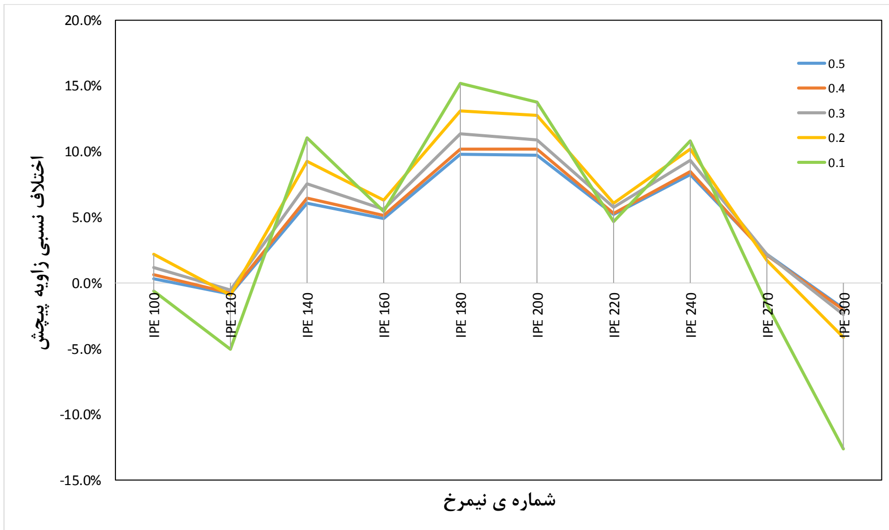
شکل ۵-۱ مقایسه نبشی جان و مفصل پیچشی
