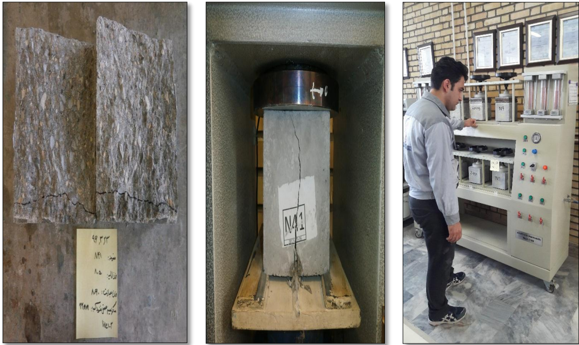
شکل ۳-۱۷: آزمایش عمق نفوذ آب تحت فشار
