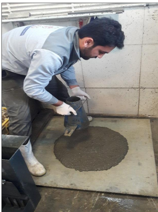
شکل ۳-۱۰: آزمایش جریان اسلامپ و T50
