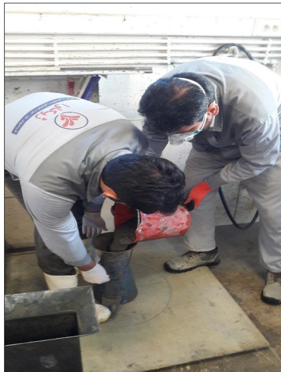
شکل ۳-۱۰: آزمایش جریان اسلامپ و T50
