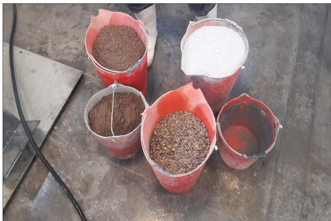
شکل ۳-۷: مصالح مصرفی برای ساخت بتن خودتراکم
