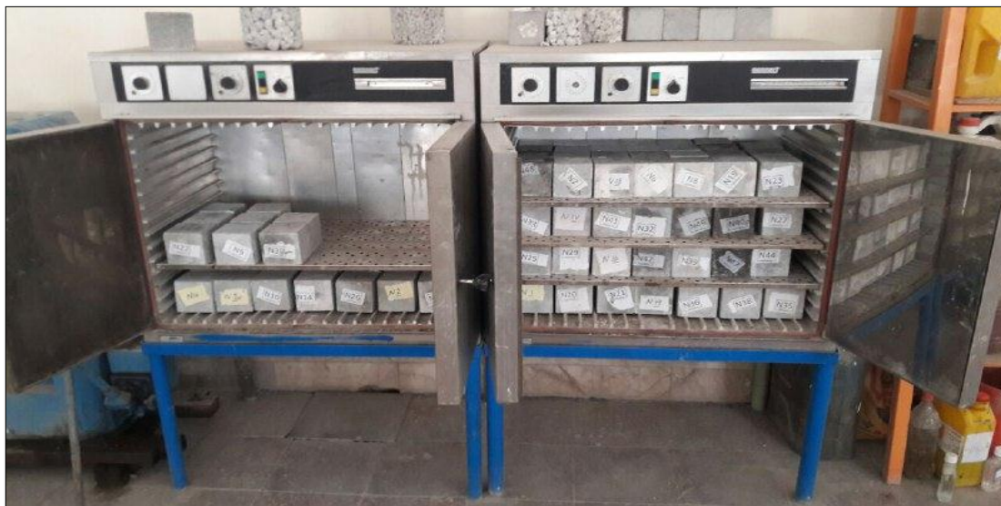
شکل ۳-۱۸: نمونه‌های داخل گرمچال آزمایش جذب آب نهایی
