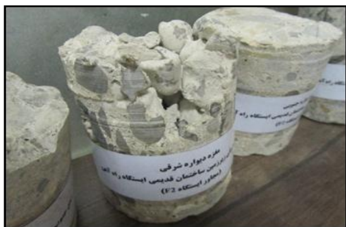
شکل ۲-۳۴: مغزه دیوار پروژه‌ای که با NC اجرا شده [۱۱]
