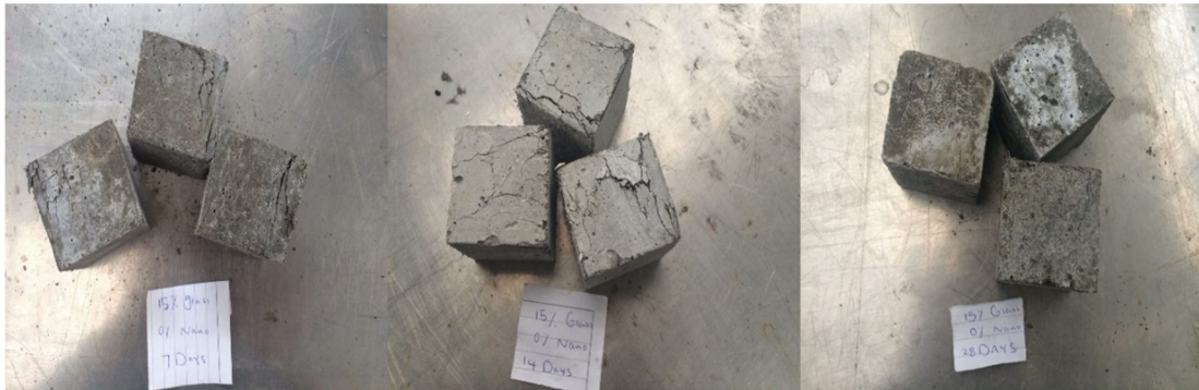
شکل ۴-۵ نمونه حاوی ۱۵ درصد پودر شیشه پس از شکست ناشی از فشار
