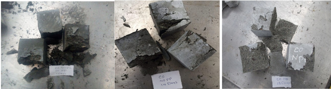
شکل ۱۳-۵ نمونه کنترل بدون الیاف پس از شکست ناشی از فشار
