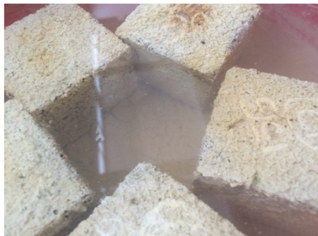
ج: شکل ظاهری نمونه‌ها ملات خودتراکم در سولفوریک اسید ۳ درصد
