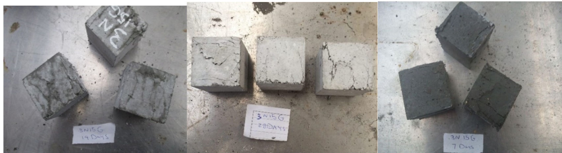
شکل ۱۱-۵ نمونه حاوی ۳ درصد پودر نانو و ۱۵٪ پودر شیشه پس از شکست ناشی از فشار
