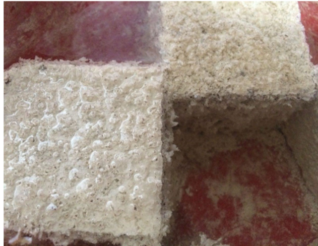
ب: شکل ظاهری نمونه‌ها ملات خودتراکم در سولفوریک اسید ۵ درصد
