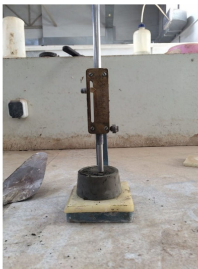
شکل ۴-۱ تعیین غلظت نرمال سیمان هیدرولیکی
