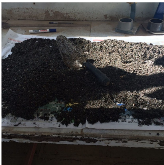
شکل ۲-۴ خشک کردن سطح ماسه برای تعیین وزن مخصوص ظاهری ناخالص
