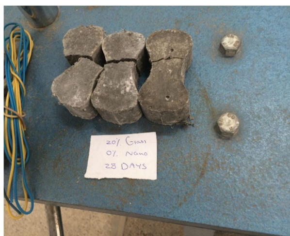
شکل ۱۷-۵ شکست نمونه حاوی ۲۰٪ پودر شیشه تحت کشش
