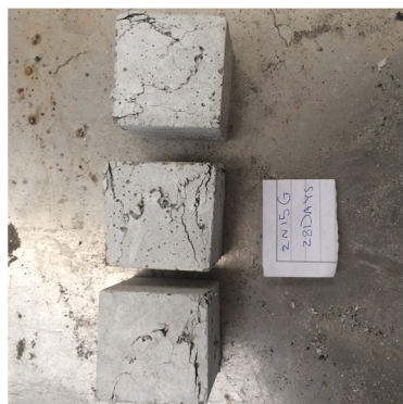
شکل ۵-۱۰ نمونه حاوی ۲ درصد پودر نانو و ۱۵٪ پودر شیشه پس از شکست ناشی از فشار
