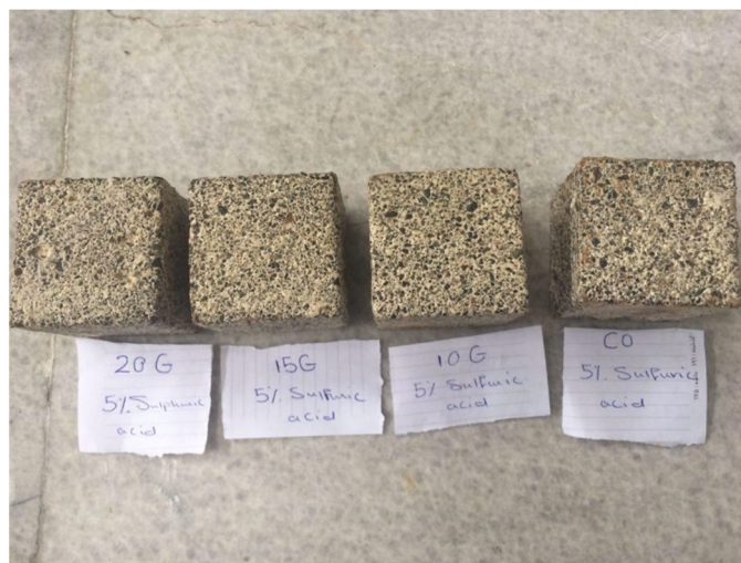
د: شکل ظاهری نمونه‌های ملات خودتراکم پس از شستن کامل نمونه‌ها شکل ۲-۶ شکل ظاهری نمونه‌ها در مرحله‌های مختلف آزمایش مقاومت اسیدی
