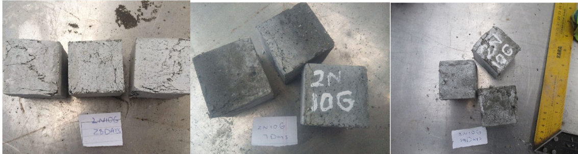
شکل ۵-۹ نمونه حاوی ۲ درصد پودر نانو و ۱۰٪ پودر شیشه پس از شکست ناشی از فشار
