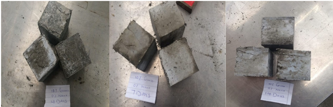
شکل ۳-۵ نمونه حاوی ۱۰ درصد پودر شیشه پس از شکست ناشی از فشار
