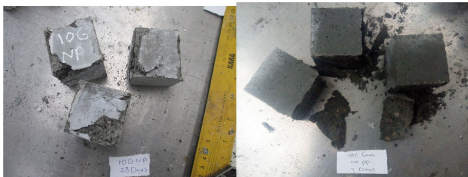
شکل ۱۴-۵ نمونه حاوی ۱۰٪ پودر شیشه بدون الیاف پس از شکست ناشی از فشار
