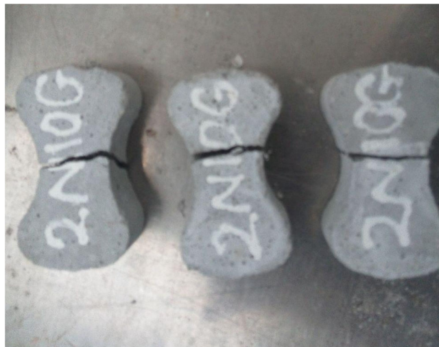
شکل ۲۱-۵ شکست نمونه حاوی ۲ درصد پودر نانو سیلیس و ۱۰ درصد پودر شیشه تحت کشش
