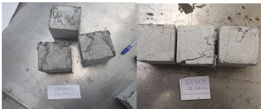
شکل ۵-۱۲ نمونه حاوی ۲ درصد پودر نانو و ۲۰٪ پودر شیشه پس از شکست ناشی از فشار
