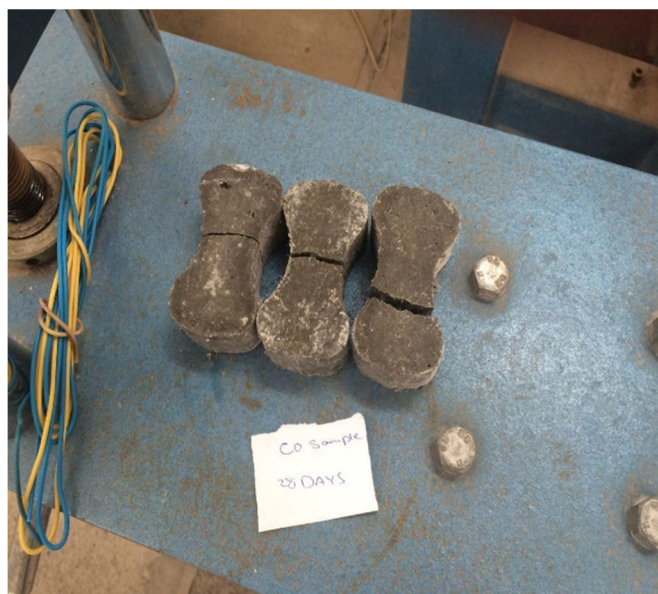
شکل ۱۵-۵ شکست نمونه کنترل تحت کشش
