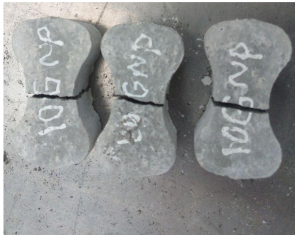
شکل ۲۳-۵ شکست نمونه حاوی ۱۰ درصد پودر شیشه تحت کشش
