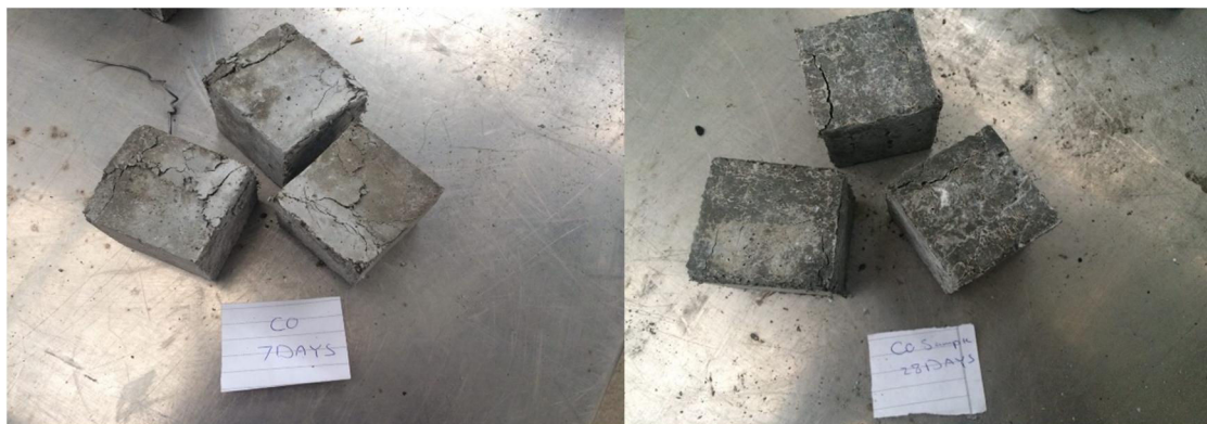
شکل ۲-۵ نمونه کنترل پس از شکست در آزمایش مقاومت فشاری
