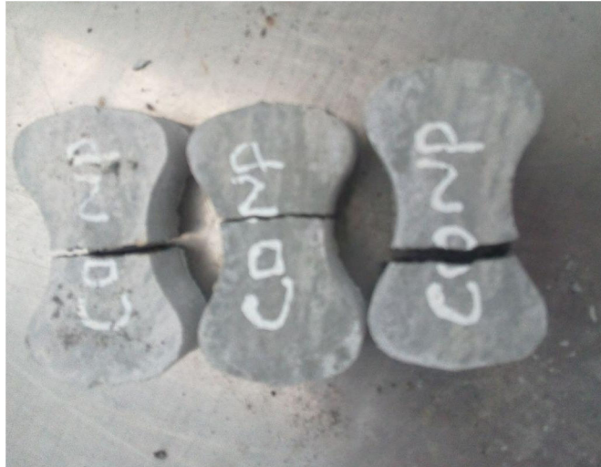
شکل ۲۲-۵ شکست نمونه کنترل بدون الیاف تحت کشش
