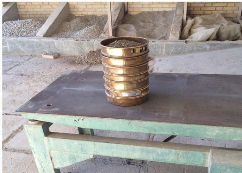
شکل ۴-۴ الک کردن ماسه برای آزمایش دانه بندی ماسه مصرفی
