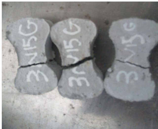
شکل ۲۰-۵ شکست نمونه حاوی ۳ درصد پودر نانو سیلیس و ۱۵ درصد پودر شیشه تحت کشش
