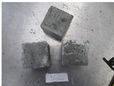
شکل ۷-۵ نمونه حاوی ۳ درصد پودر نانوسیلیس پس از شکست ناشی از فشار
