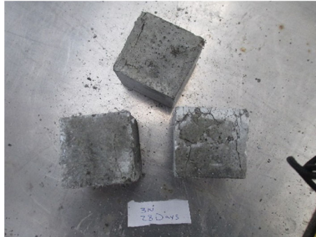
شکل ۵-۶ نمونه حاوی ۲ درصد پودر نانو پس از شکست ناشی از فشار
