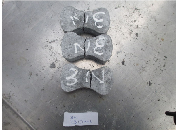
شکل ۱۹-۵ شکست نمونه حاوی ۳٪ پودر نانو تحت کشش
