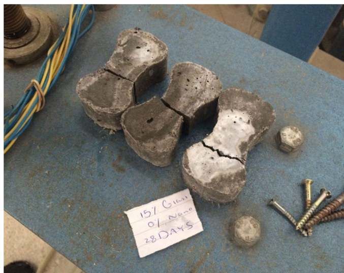
شکل ۱۶-۵ شکست نمونه حاوی ۱۵٪ پودر شیشه تحت کشش
