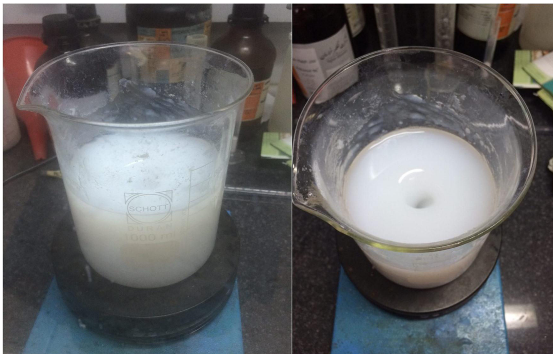
شکل ۳-۴ تبدیل نانو سیلیس جامد به مایع نانو سیلیس
