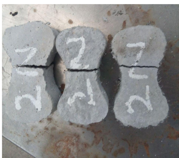
شکل ۱۸-۵ شکست نمونه حاوی ۲ درصد پودر نانو تحت کشش
