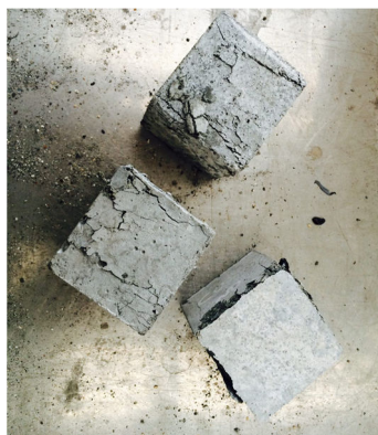
شکل ۵-۸ نمونه حاوی ۴ درصد پودر نانو پس از شکست ناشی از فشار
