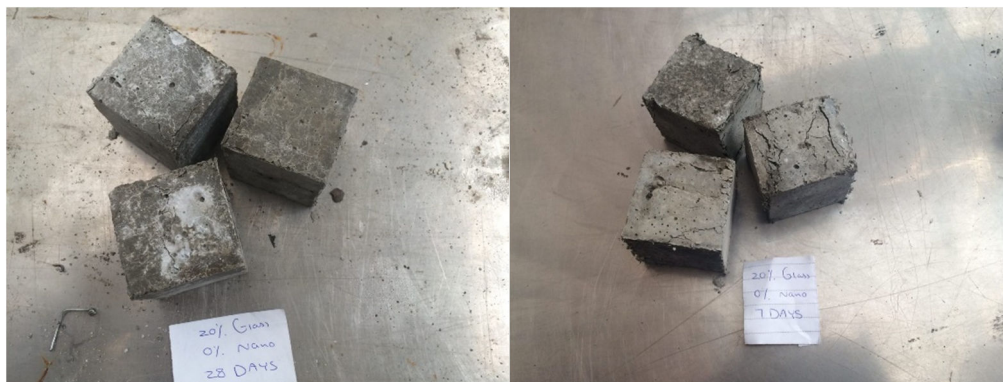
شکل ۵-۵ نمونه حاوی ۲۰ درصد پودر شیشه پس از شکست ناشی از فشار
