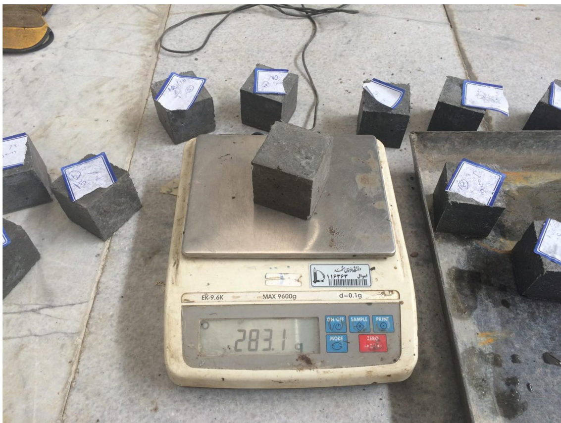
شکل ۳-۸ توزین نمونه ها در آزمایش جذب آب
