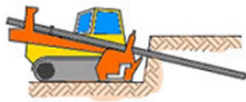
۲- حفر گمانه میخ
