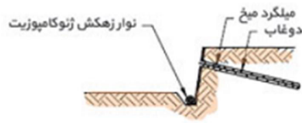
۳- استقرار میلگرد و تزریق دوغاب (همچنین نصب نوارهای زهکش)
