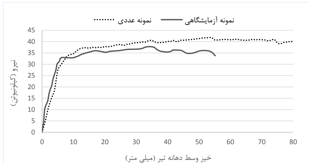
شکل (۵-۱۶) مقایسه‌ی تغییرات نیروی خمشی وسط دهانه‌ی نمونه‌ی آزمایشگاهی گو و همکاران با مدل اجزای محدود
