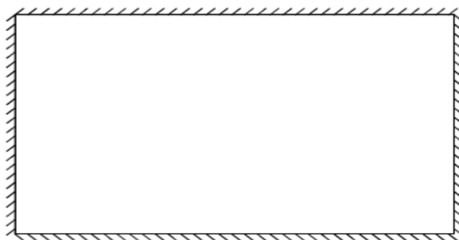
شکل ۴-۳۳ ورق صاف مستطیلی با تکیه‌گاه گیردار [۵۴]
