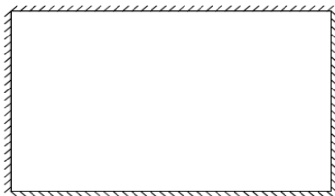
شکل ۴-۱۰ ورق صاف مستطیلی با تکیه‌گاه گیردار [۵۴]
