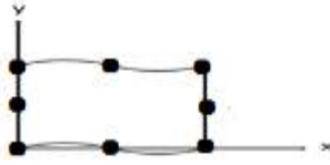
شکل ۳۱-۵ المان موجدار هشت گره‌ای برای دیوار برشی فولادی موجدار
