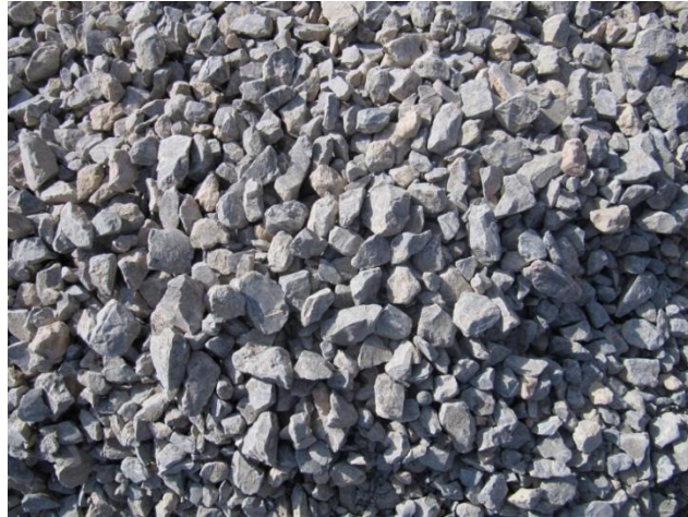
شکل ۳-۳- استفاده از قلوه سنگ با ضریب تخلخل ۲۵ درصد در تالابها
