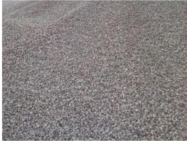
شکل ۲-۳- استفاده از شن با ضریب تخلخل ۳۵ درصد در تالابها
