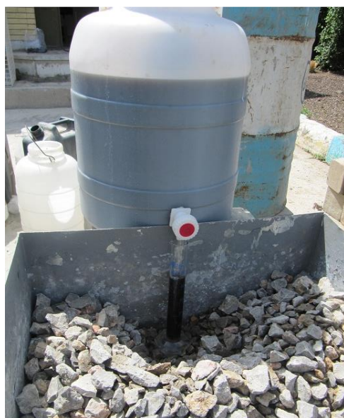
شکل ۳-۱۳- نحوه تنظیم کردن شدت جریان ورودی
