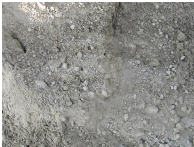
شکل ۳-۱- استفاده از ماسه با ضریب تخلخل ۴۸ درصد به عنوان بستر رشد گیاهان در تالابها
