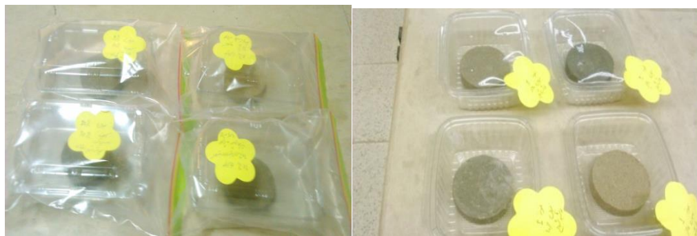
شکل (۱۱-۳): نمونه‌های حاوی سیمان بعد از نمونه‌سازی شکل (۱۲-۳): قرار دادن نمونه‌ها در زیپ کیپ به منظور ثابت ماندن رطوبت.
