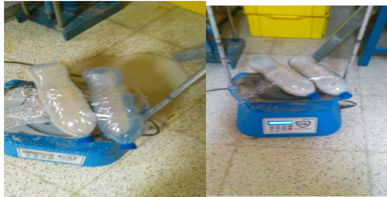
شکل (۱۷-۳) : استفاده از شیکر نامناسب در مرحله اول
