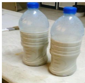
شکل (۱۶-۳) : آماده شدن سوسپانسیون حاوی بنتونیت و الکترولیت با نسبت مشخص
