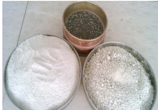
شکل (۸-۳): آماده‌سازی خاک (خاک عبوری از الک نمره ۱۰ خمیری) شکل (۹-۳): خاک مرطوب (رطوبت حد
