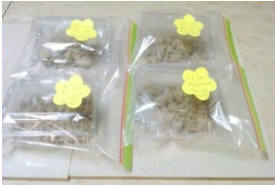
شکل (۸-۳): آماده‌سازی خاک (خاک عبوری از الک نمره ۱۰ خمیری) شکل (۹-۳): خاک مرطوب (رطوبت حد
