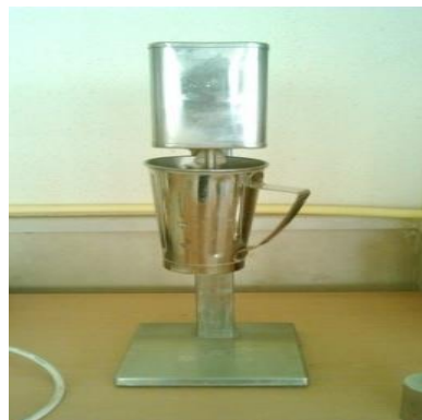
شکل (۱۷-۳) : استفاده از شیکر نامناسب در مرحله اول
