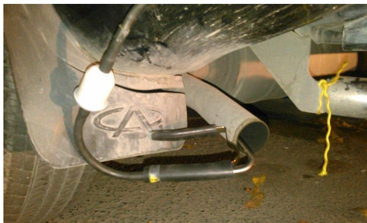
شکل ۴-۲ اتصال دستگاه AVL به اگزوز
