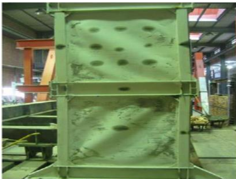
شکل ۷-۲ نمونه آزمایشگاهی اول در انتهای آزمایش محرمی و همکاران [۹]
