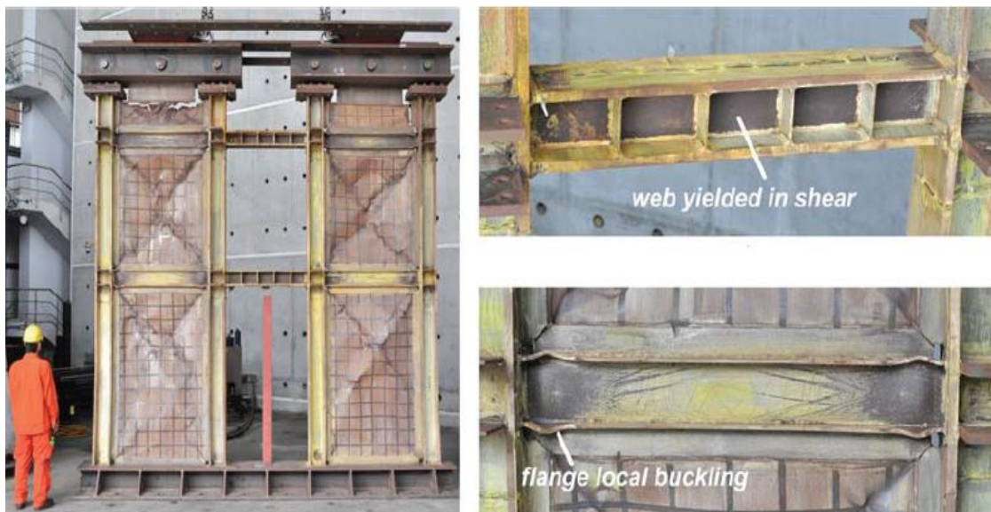
شکل ۲-۱۷ آزمایش‌ها دیوار برشی فولادی کوبله لی و همکاران [۱۵]
