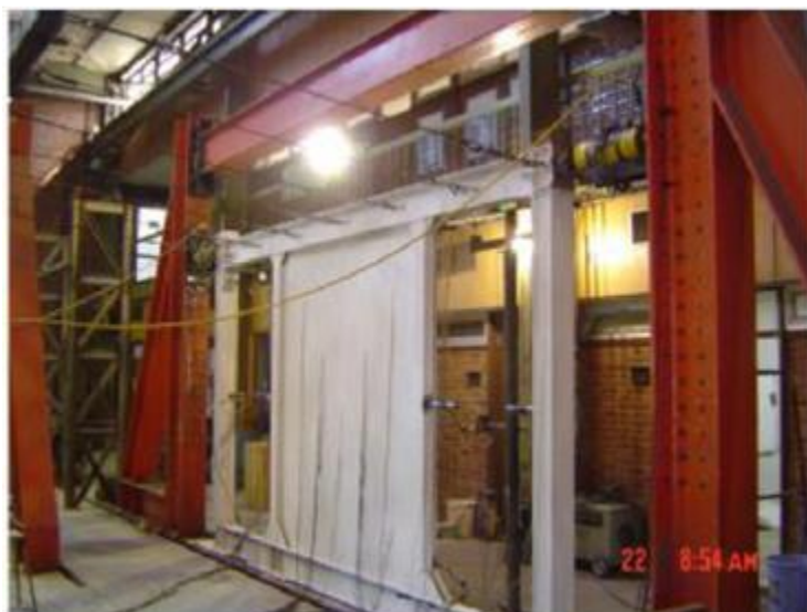
شکل ۱۰-۲ سیستم قاب-دیوار قبل از آزمایش سری سوم [۱۰]
