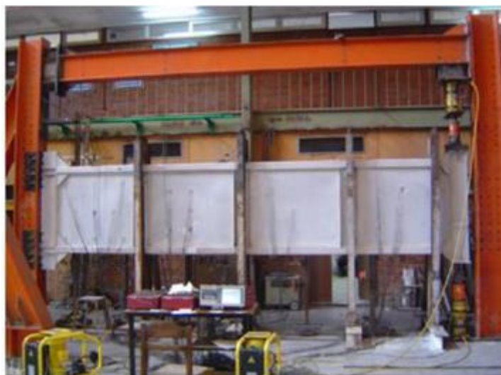
شکل ۹-۲ نمونه اول سری دوم آزمایش‌ها محرمی و همکاران - پانل چهار طبقه [۱۰]
