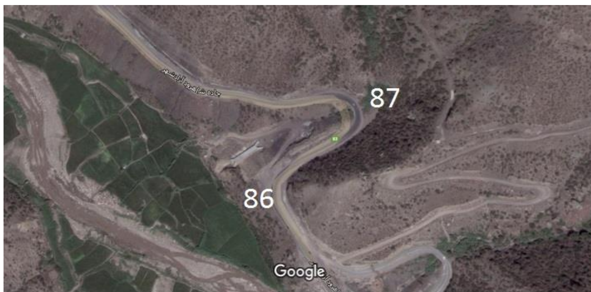
شکل ۴-۱۳: قوس‌های غیر ایمن مسیر شاهرود به آزادشهر (قوس‌های ۸۶ و ۸۷)
