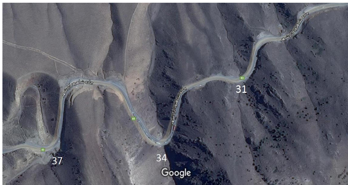
شکل ۴-۹: قوس های غیرایمن مسیر شاهرود به آزادشهر (قوس های ۳۱، ۳۴ و ۳۷)
