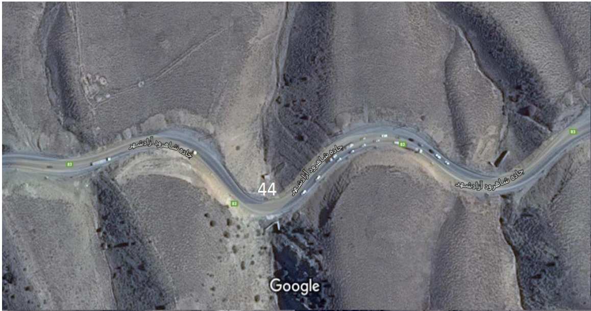
شکل ۴-۱۰: قوس‌های غیرایمن مسیر شاهرود به آزادشهر (قوس ۴۴)
