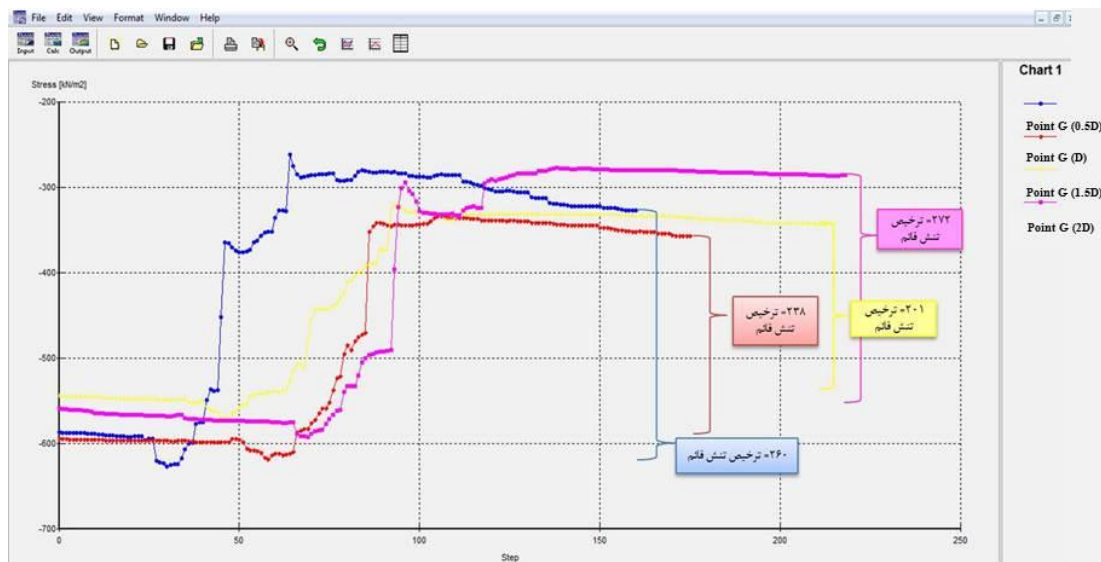
شکل (۶-۳۹): تنش قائم نقطه‌ی G برحسب گامهای محاسباتی (step) برای چهار مدل
