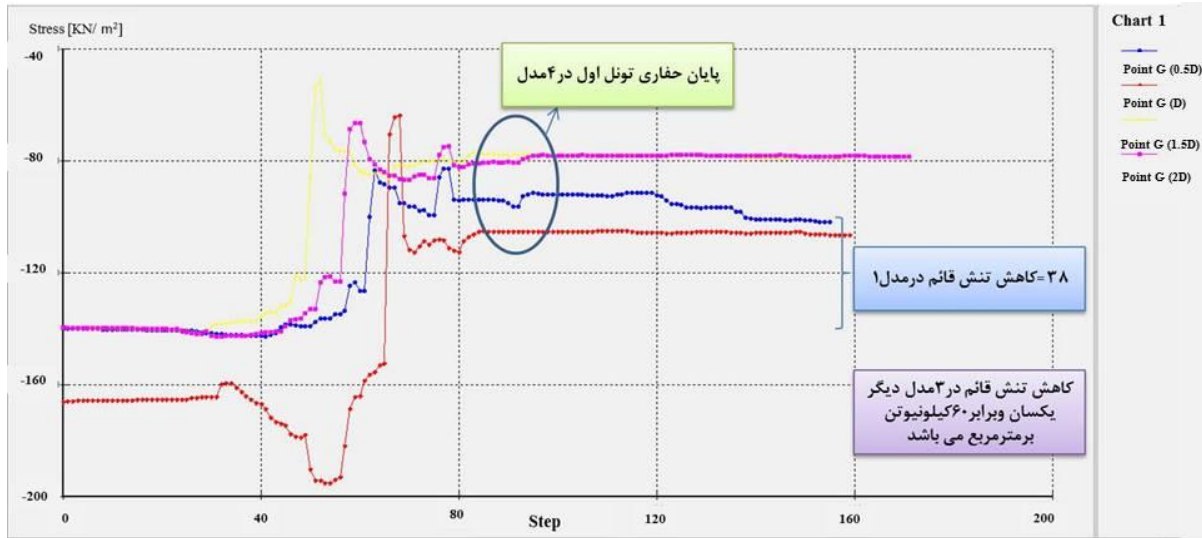
شکل (۶-۱۰): تنش قائم پشت لاینینگ نقطه‌ی G در مقابل گام‌های محاسباتی (step) برای چهار مدل
