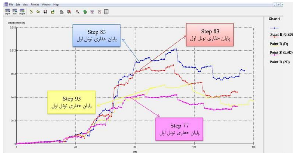
شکل (۶-۱۶): جابه‌جایی نقطه‌ی B بر حسب گام‌های محاسباتی (step) در چهار مدل
