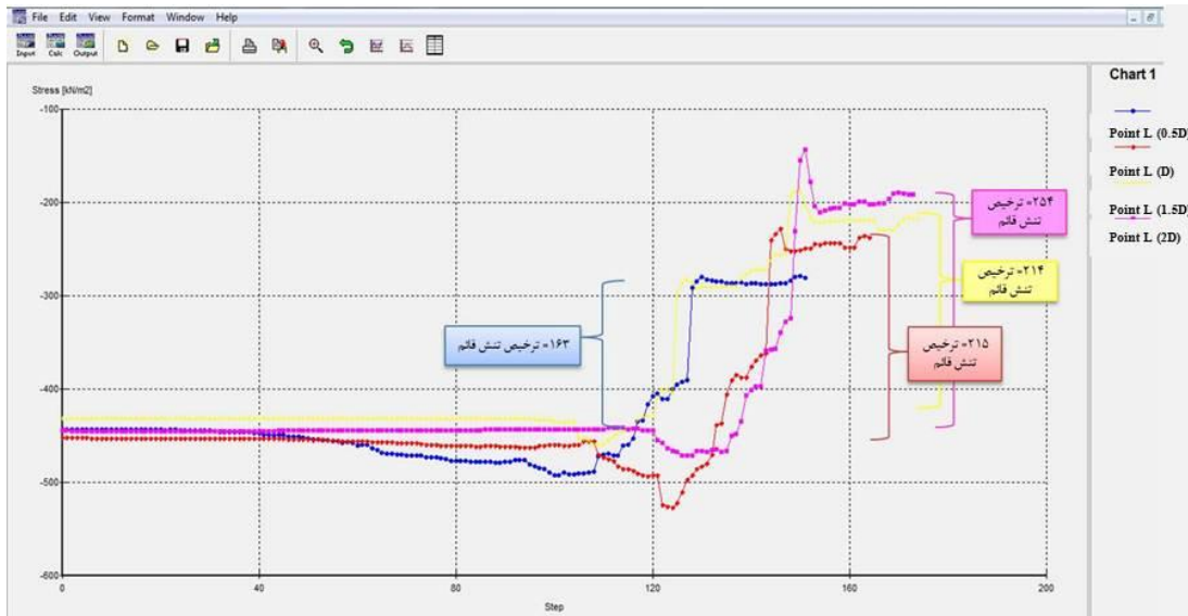
شکل (۶-۳۱): تنش قائم نقطه‌ی L برحسب گامهای محاسباتی (step) برای چهار مدل
