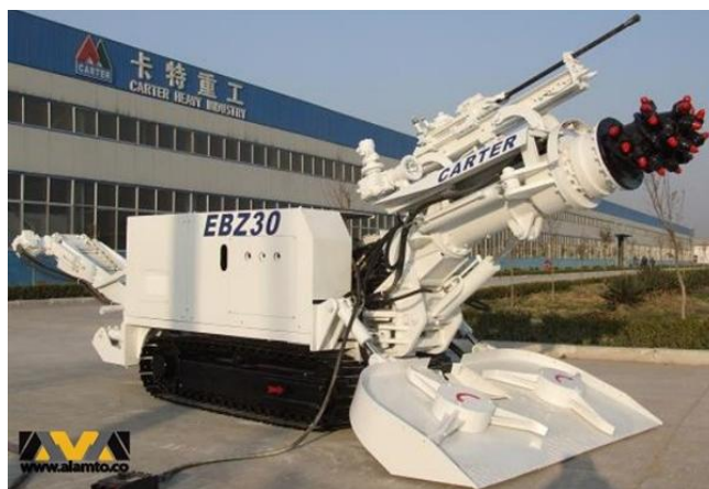
شکل شماره‌ی (۱-۶): نمونه‌ای از ماشین حفار با سرمته‌ی محوری
