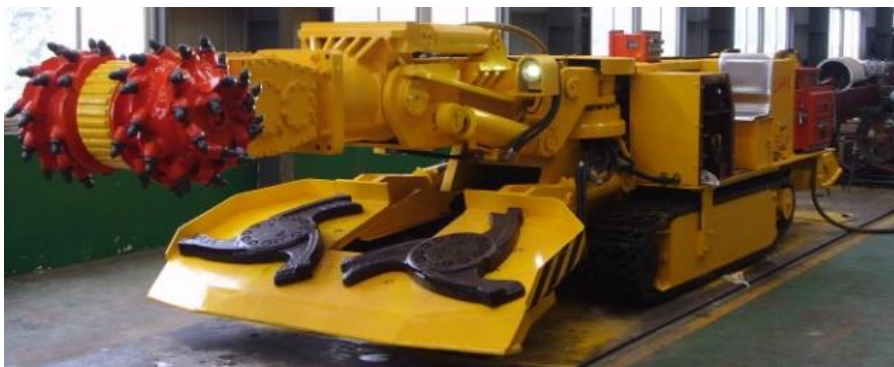
شکل شماره‌ی (۱-۷): نمونه‌ای از ماشین حفار با سرمته‌ی عرضی
