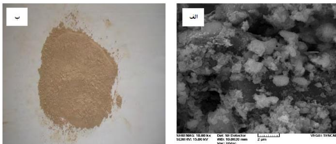
شکل ۴-۳ الف: تصویر میکروسکوپ الکترونی از ذرات خاکستر لجن فاضلاب، ب: تصویر نمونه خاکستر لجن پس از آسیاب
