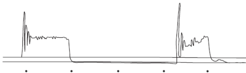
شکل ۱-۲ فشار ثبت شده جدایی ستون. محور افقی زمان (هر نقطه نیم ثانیه) و محور عمودی فشار
