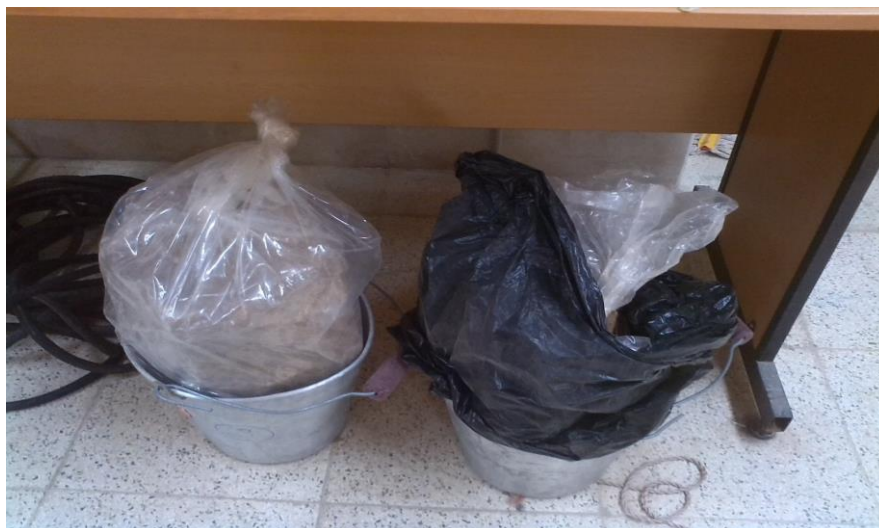
شکل ۳-۱-۱: نمونه برداری دست نخورده از خاک مورد نظر
