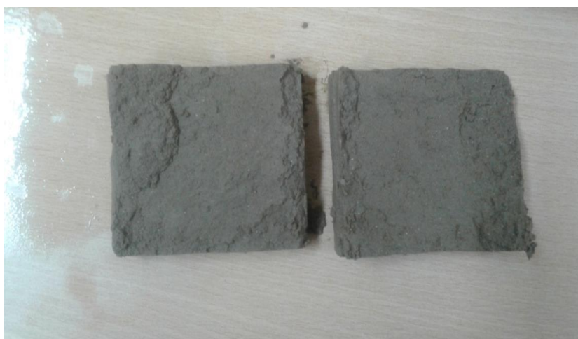
شکل ۳-۲: نمونه بازسازی شده از خاک دست خورده از وسط قالب تراکم
