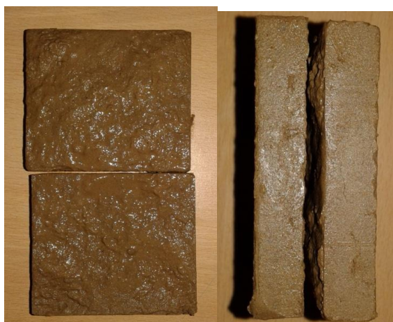
شکل ۳-۱۴: نمونه ی پس از برش در دستگاه برش مستقیم (قالب مربعی).
