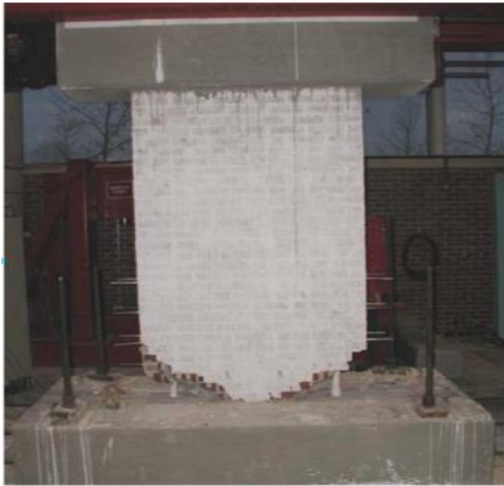
شکل (۳-۲۰) شکست در نمونه آزمایشگاهی
