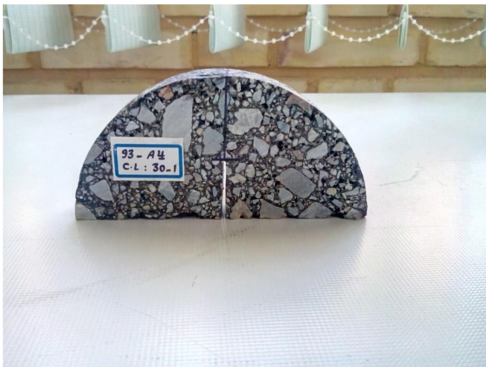
شکل ۴-۸ : کدگذاری نمونه‌ها قبل از قرار دادن آنها درون فریزر
