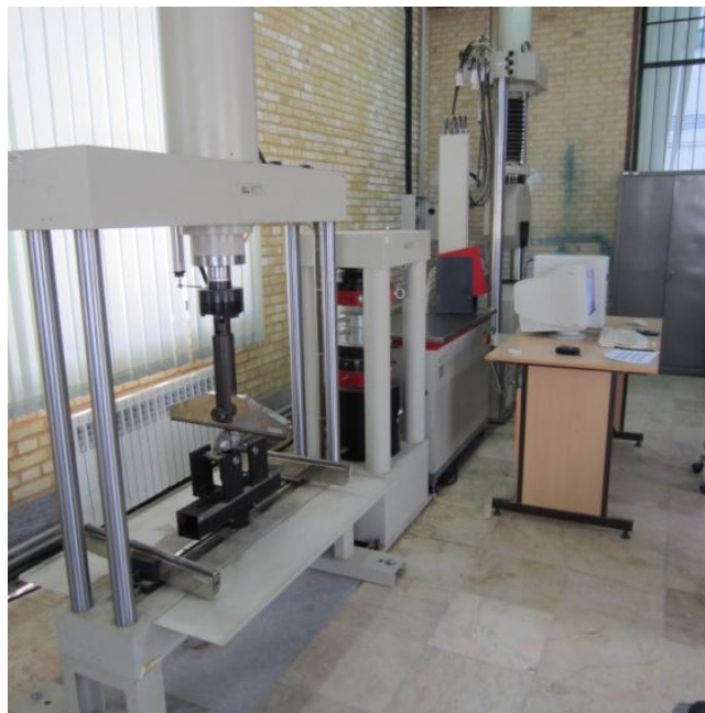
شکل ۴-۴: نمای کلی از دستگاه بارگذاری خمش سه نقطه‌ای
