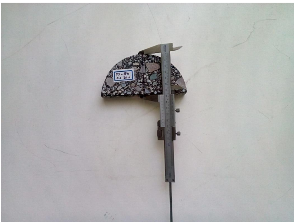
شکل ۴-۷: اندازه‌گیری ابعاد نمونه‌ها با استفاده از کولیس
