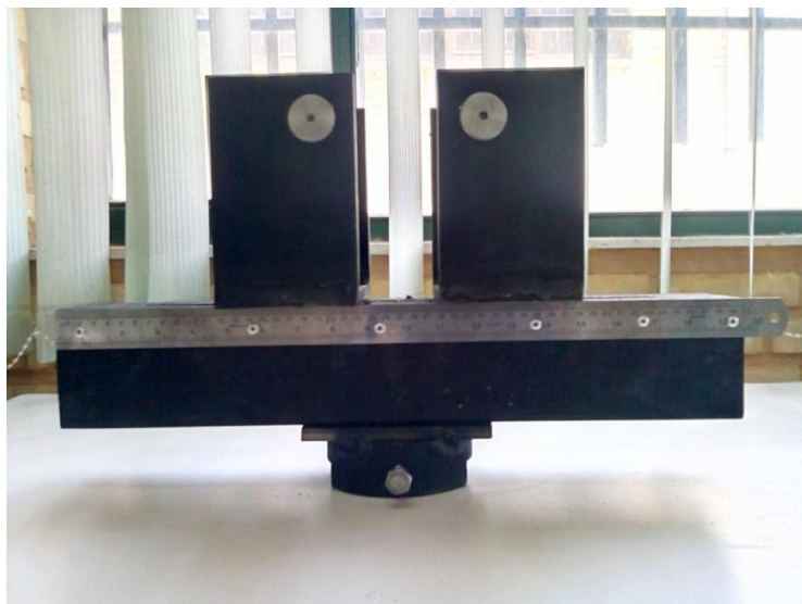
شکل ۴-۵: فیکسچر ساخته شده برای بارگذاری خمش سه نقطه‌ای
