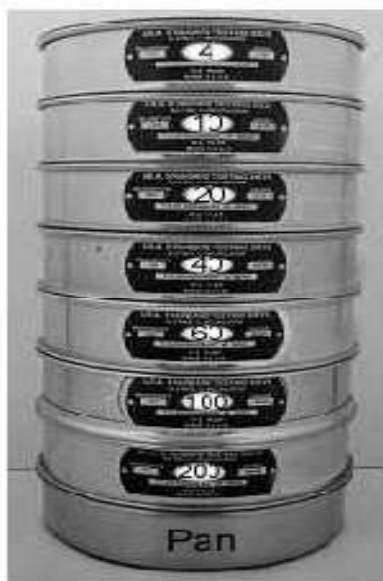
شکل ۳-۵: الکهای آزمایش دانه بندی به روش تر (قسمت درشت دانه)
