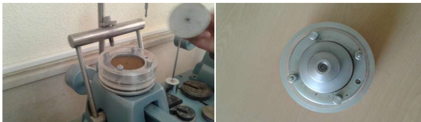
شکل ۴-۱۸ : دستگاه تحکیم یک بعدی (ادئومتر) و رینگ آن
