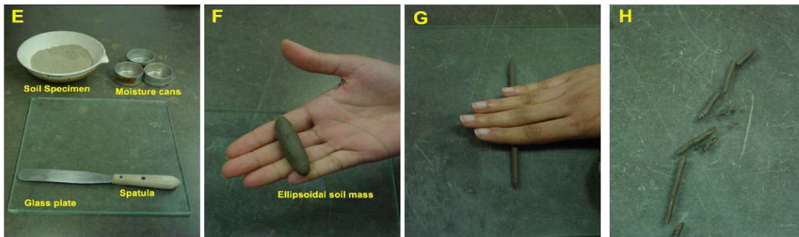
شکل ۳-۹: وسایل آزمایش حد پلاستیک ومراحل انجام آزمایش
