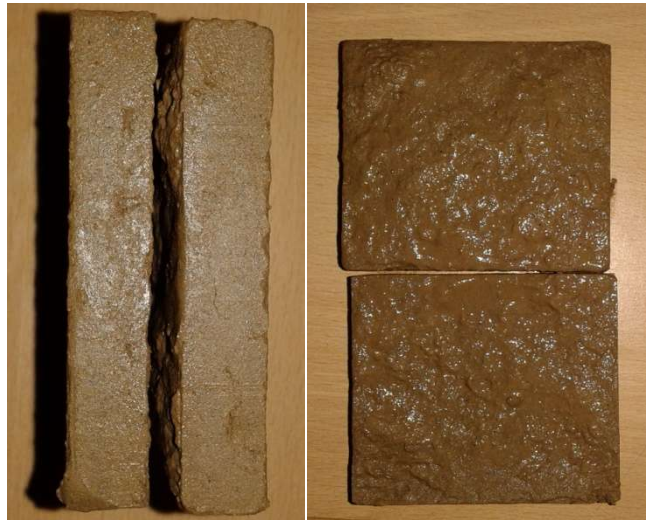
شکل ۴-۱۷: نمونه ی پس از برش در دستگاه برش مستقیم (قالب مربعی)
