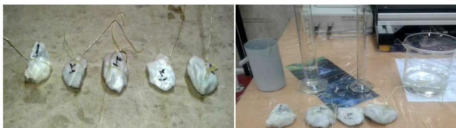
شکل ۳-۱۴: لوازم آزمایش تعیین دانسیته خشک طبیعی و کلوخه های آغشته به پارافین.
