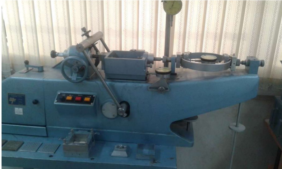
شکل ۲-۵: دستگاه برش مستقیم آزمایشگاه مکانیک خاک دانشگاه صنعتی شاهرود
