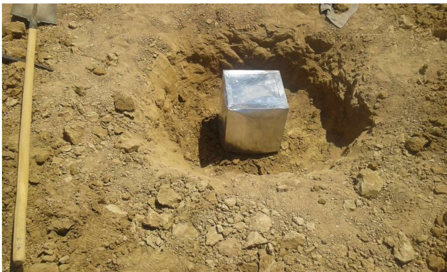
شکل ۳-۳: روش نمونه برداری دست نخورده از خاک مورد نظر
