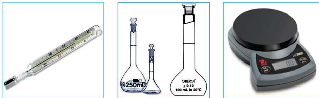
شکل ۳-۱۳: برخی از وسایل آزمایش تعیین چگالی ویژه بخش جامد خاکهای ریزدانه
