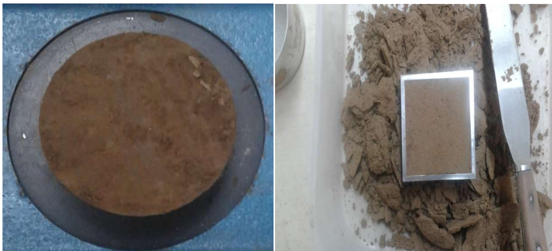
شکل ۳-۴: نمونه بازسازی شده از خاک دست خورده از وسط قالب تراکم
