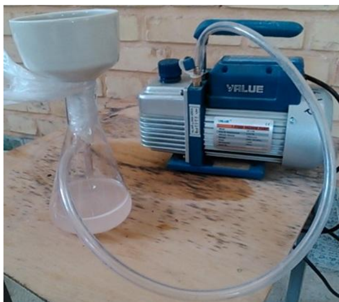
شکل ۲-۳: سیستم فیلتراسیون تحت شرایط خلاء
