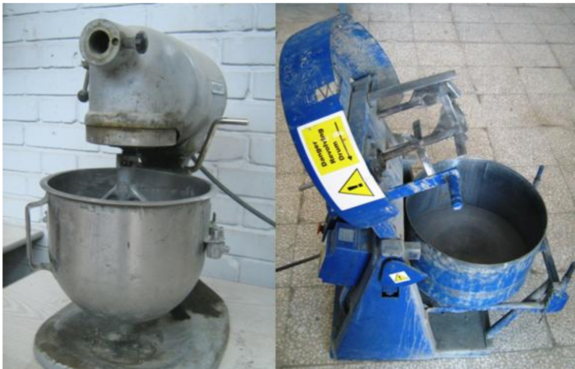
شکل ۴-۱ مخلوط‌کن‌های بکار رفته در ساخت نمونه‌ها
