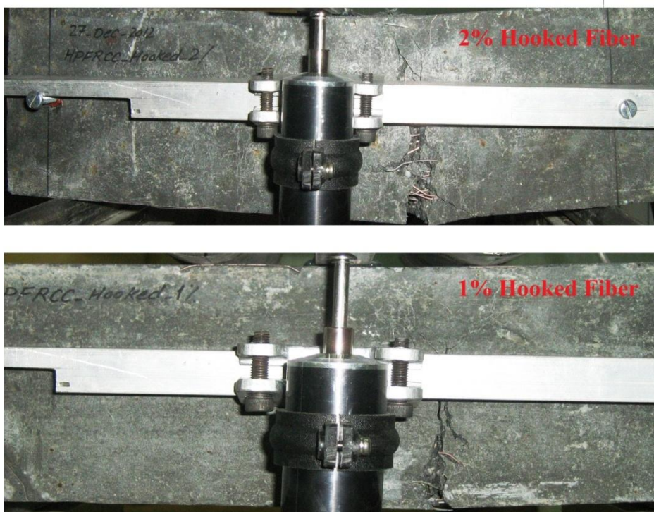
شکل ۶-۱۱ نحوه ترک‌خوردگی نمونه‌ها
