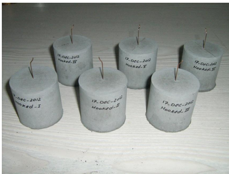
شکل ۴-۲۳ نمونه‌های آزمایش بیرون کشیدن الیاف
