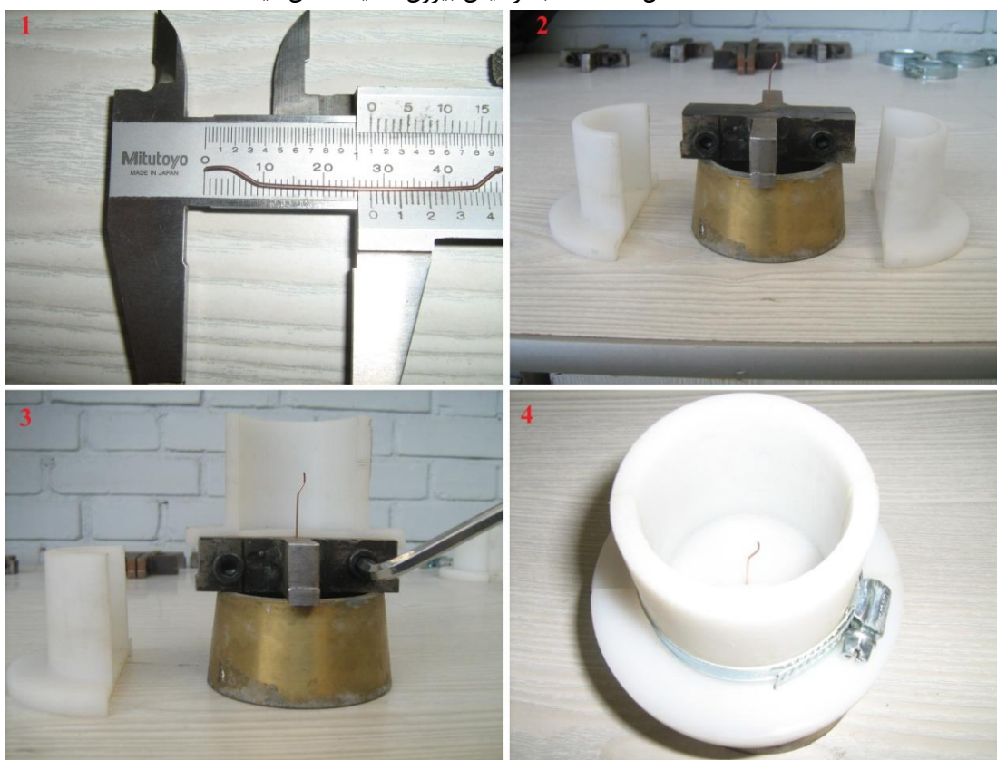
شکل ۴-۱۸ مراحل قرار دادن الیاف در داخل قالب
