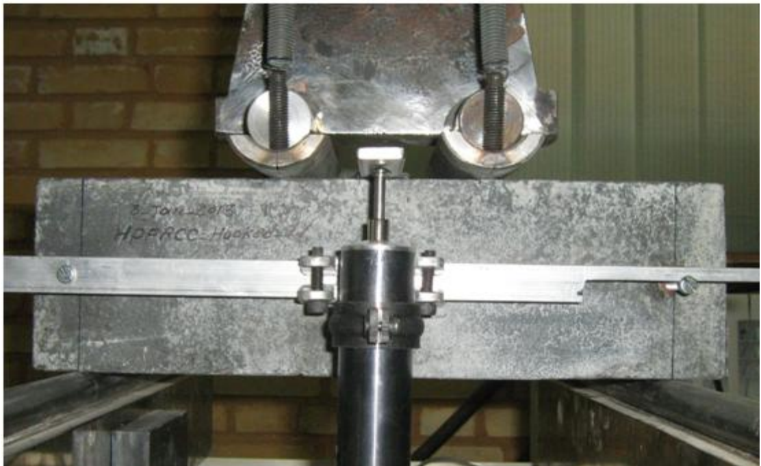
شکل ۶-۶ هندسه نمونه‌ها و چیدمان آزمایش مقاومت خمشی
