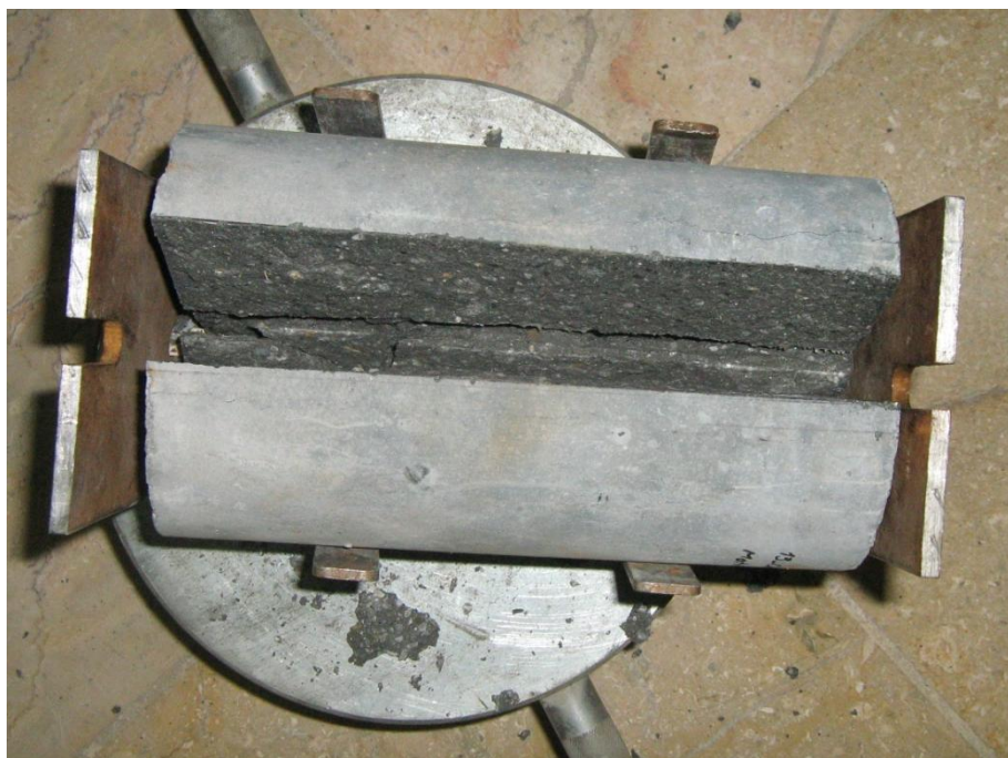
شکل ۴-۱۲ حالت گسیختگی نمونه در آزمایش مقاومت کششی دونیم شدن جدول ۴-۱۱ نتایج آزمایش مقاومت کششی دونیم شدن
