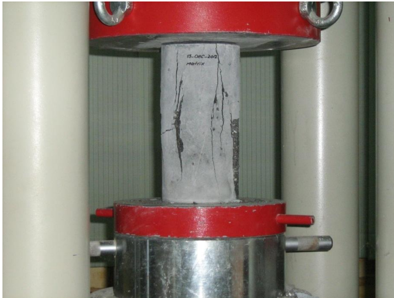
شکل ۴-۷ نمونه فشاری در انتهای روند بارگذاری
