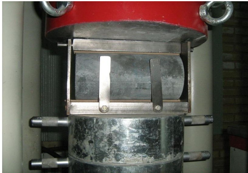
شکل ۴-۹ تجهیزات و نحوه بارگذاری آزمایش دونیم شدن
