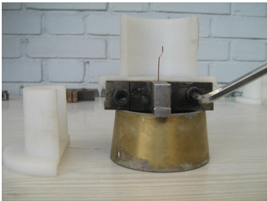
شکل ۴-۱۷ قالب آزمایش بیرون کشیده شدن الیاف
