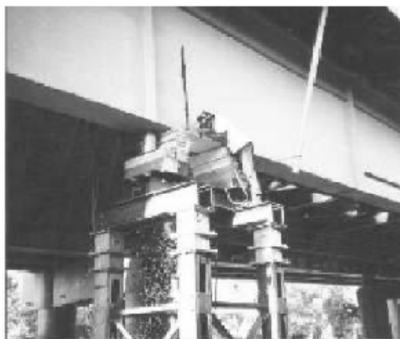
شکل 3-1: آزمایش لرزه ای بر روی پل I-40 در نیو مکزیکو
