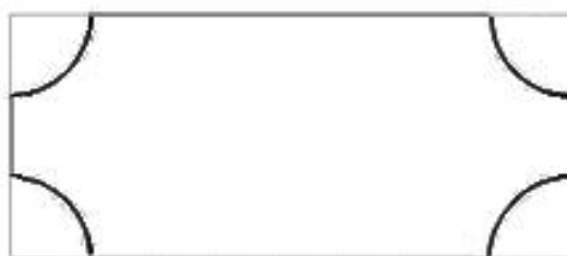
شکل ۵-۵ - نمونه مورد مطالعه به منظور بررسی اثر سخت‌کننده در بازشو به شکل ربع دایره
