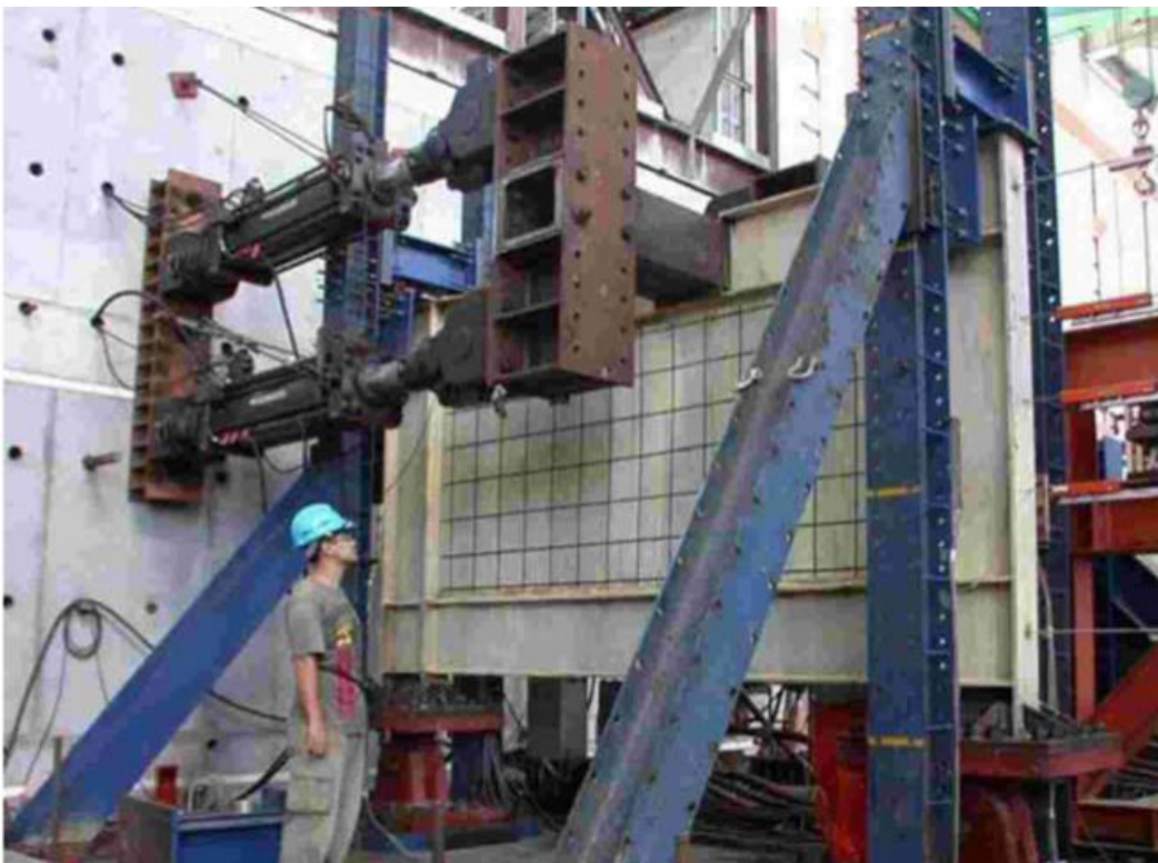
شکل ۳-۸- نمونه‌ی آزمایشگاهی و نحوه‌ی قرارگیری جک‌ها [۸]
