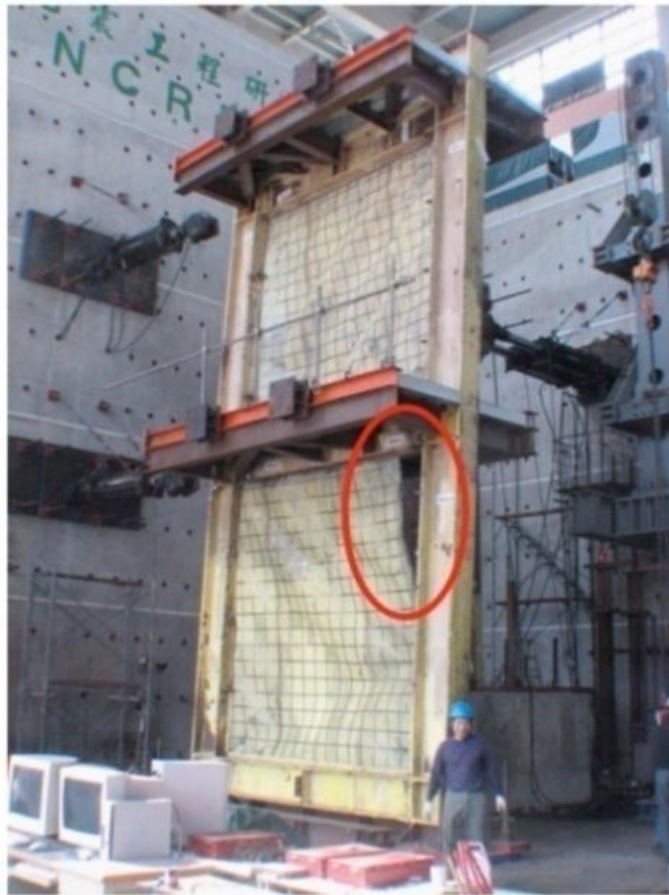
شکل ۲-۲۶- گسیختگی اتصال جوشی پانل از ورق پشت‌بند [۱۸]
