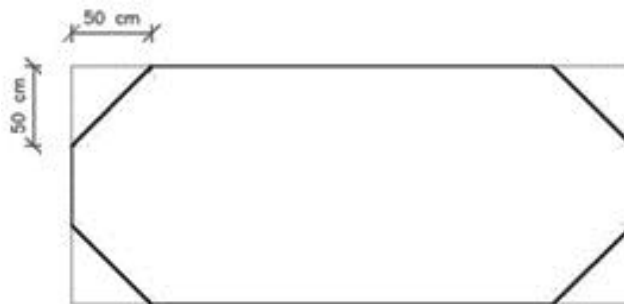
شکل ۴-۴- حفره‌های موجود در پانل نمونه ST-4-T-L50
