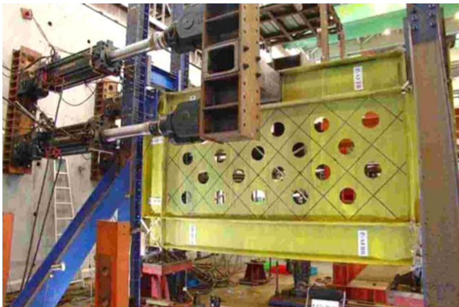
شکل ۲-۲۵- یکی از نمونه‌های آزمایشگاهی وین (Vian) و همکاران (با حفره‌های متعدد در راستای ۴۵ درجه) [۱۵]
