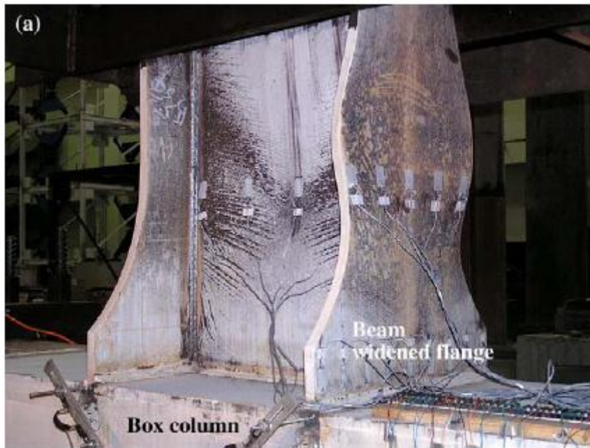
شکل ۳-۲۶- نمونه W10-L1A در انتهای دررفت ۴٪
