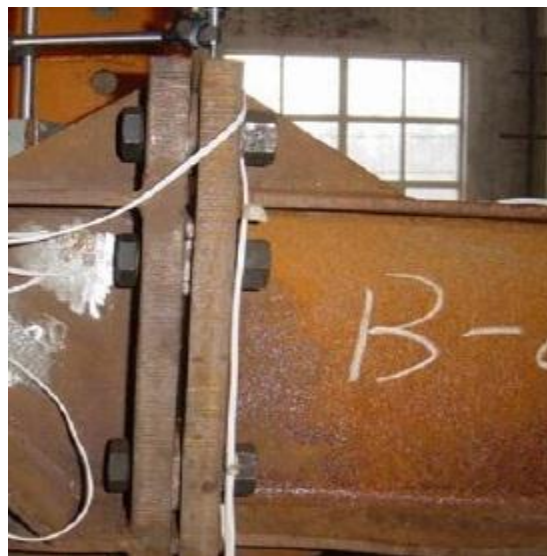
شکل ۳-۳۲-مدلسازی آزمایشگاهی نقص اولیه در اتصال ورق انتهایی فلنجی
