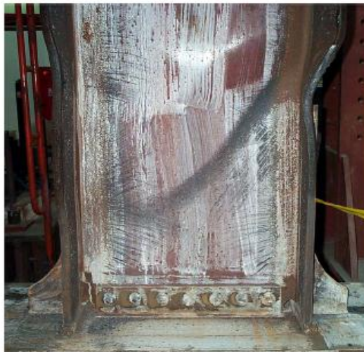
شکل ۴-۱۵- کمانش موضعی جان و بال تیر نمونه BR115SB
