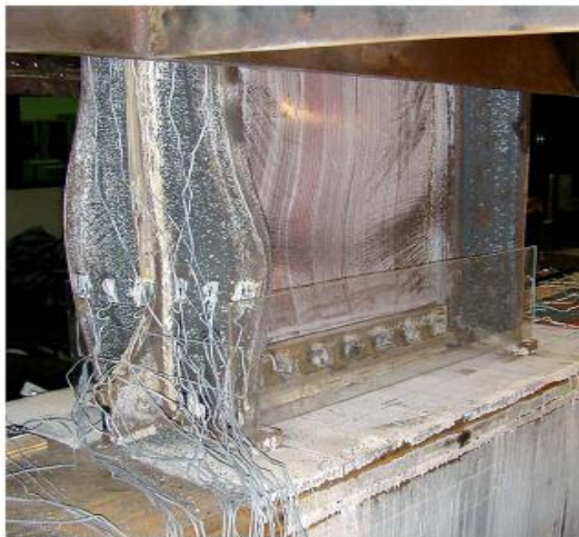
شکل ۴-۱۶- کمانش موضعی جان و بال تیر نمونه BR105SB
