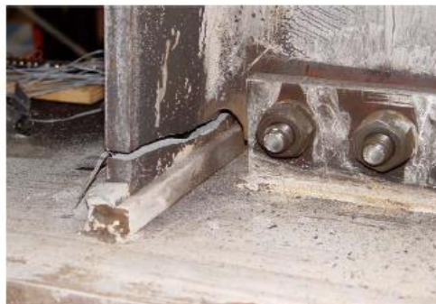
شکل ۳-۸- شکست ترد در نمونه تقویت نشده
