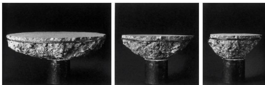
شکل (۹-۲) مخروط برش پانچ با زوایای تمایل ۳۰، ۴۵ و ۶۰ درجه
