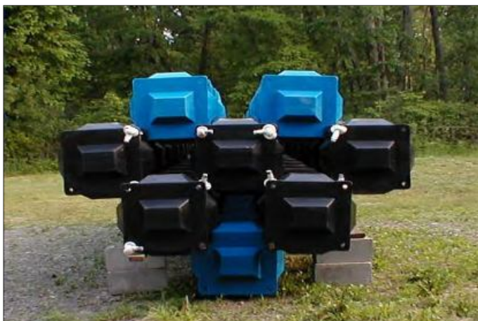
شکل (۲-۱۹) نمونه‌ای از موج‌شکن شناور نوع ترمز موج
