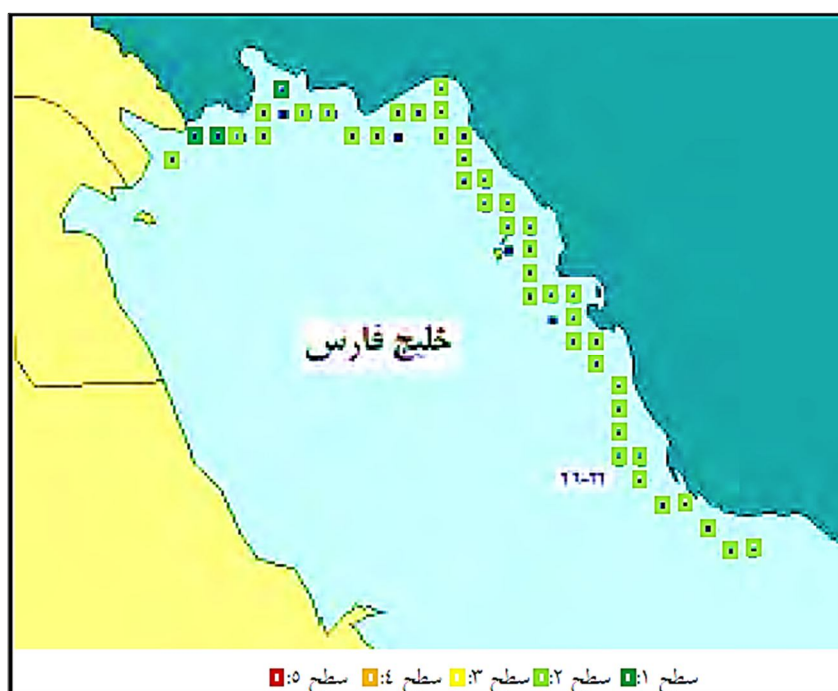
شکل (۱۱-۱) سطح توصیه پذیری نقاط خلیج فارس برای احداث موج شکن شناور
