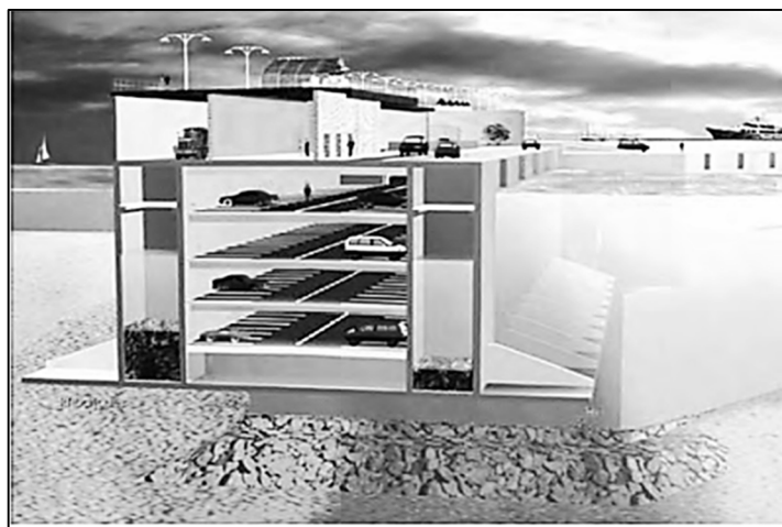
شکل (۲-۱۲) نمونه‌ای از یک موج‌شکن شناور کیسونی
