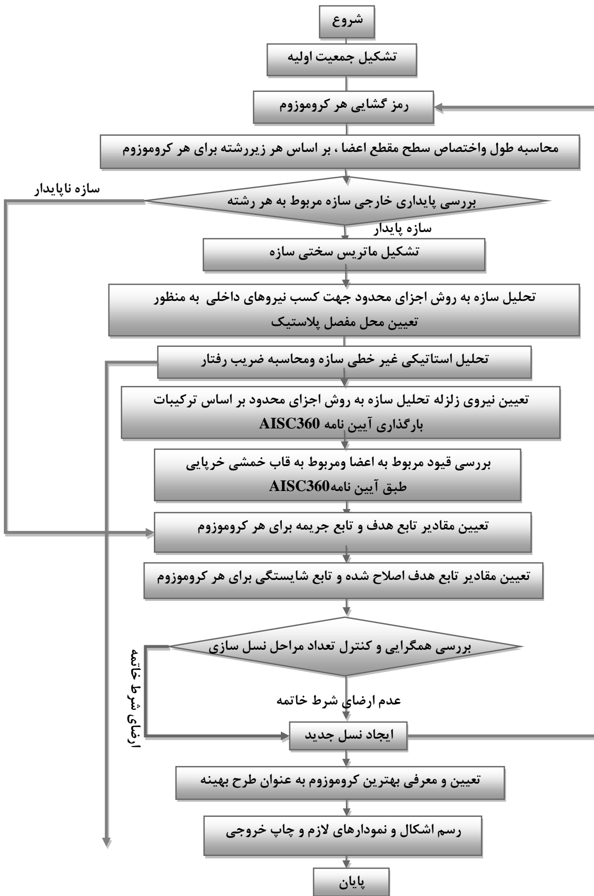
شکل (۶-۲) فلوجارت بهینه سازی قاب خمشی خرابایی ویژه به کمک الگوریتم ژنتیک
