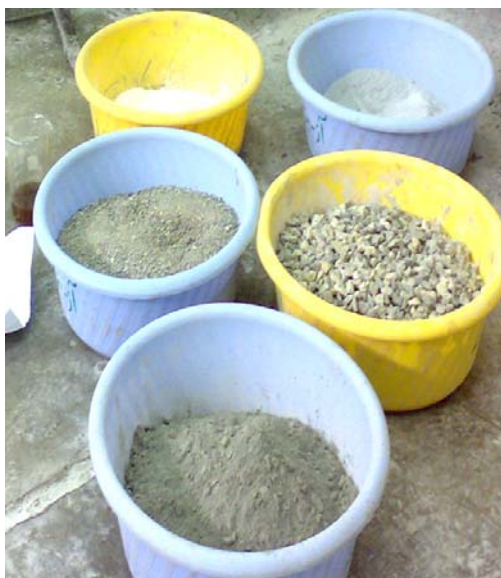
شکل ۳-۶ ب) مواد اختلاط ۱. میکروسیلیس ۲. پودر سنگ ۳. شن ۴. ماسه ۵. سیمان
