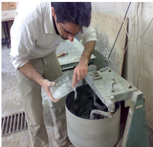
شکل ۳-۶ الف) افزودن الیاف به مخلوط
