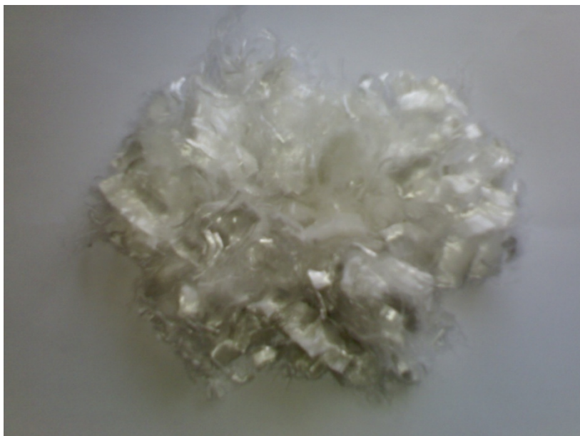
شکل ۳-۳: الیاف پلی پروپیلین
