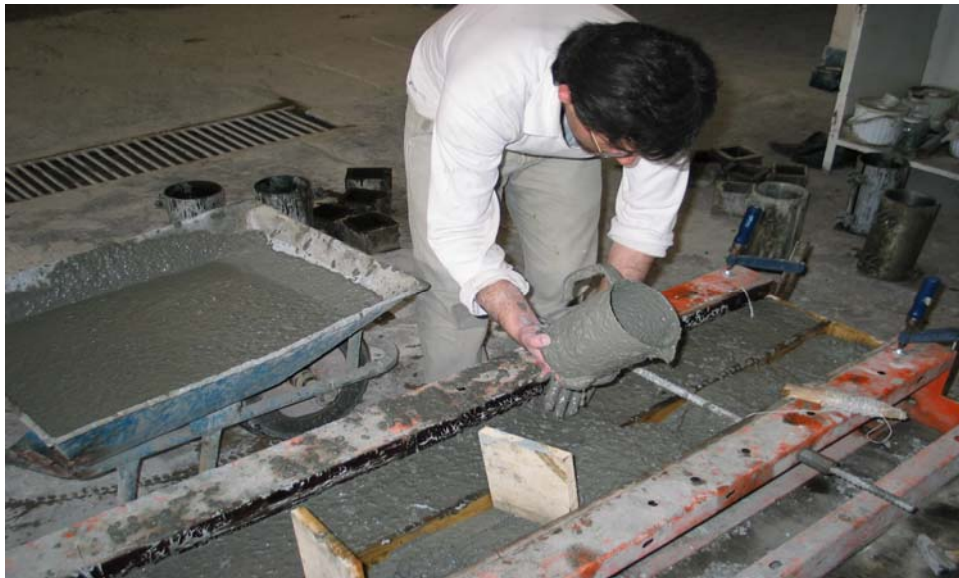
شکل ۳-۱۶ بتن ریزی تیرها
