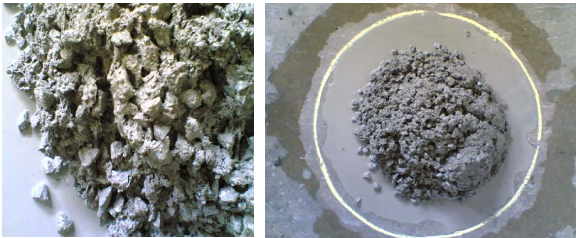
شکل ۳-۴ جدایی دانهها در اثر افزودن آب اضافی به بتن الیافی خودمتراکم
