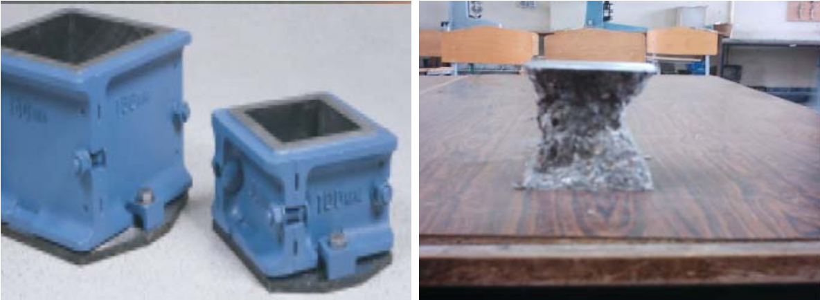
شکل ۳-۱۱: نمونه مکعبی شکسته شده فاقد الیاف تحت بار محوری فشاری
