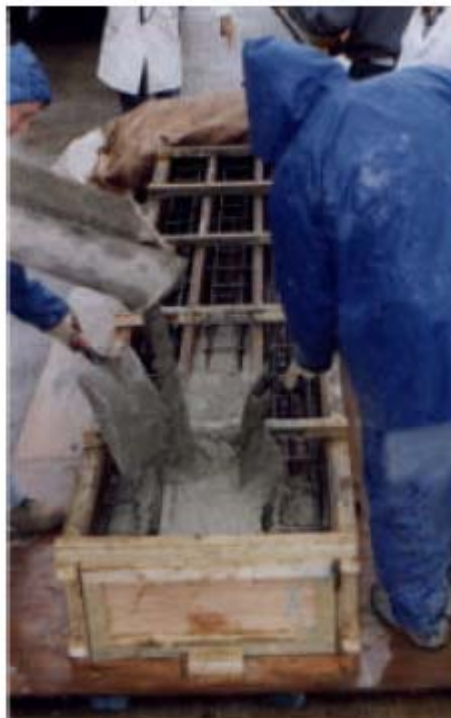
شکل ۲-۴۱ بتن ریزی تیرهای SCC [17]
