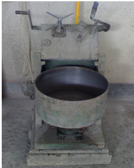
شکل ۳-۵: دستگاه مخلوط کن با ظرفیت ۲۰ کیلوگرم بتن برای اختلاط های اولیه
