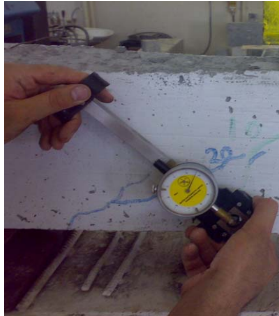
شکل ۳-۱۸ دستگاه کرنش سنج
