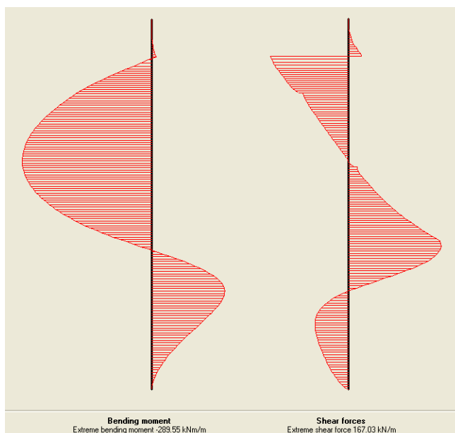
شکل ۵-۱۴- نمودار نیروی برشی و لنگر خمشی- تغییر شکل سیستم- کاهش سطح مقطع مهار تا ۵۰٪
