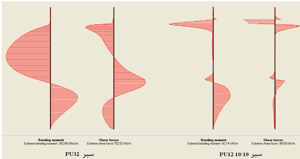
شکل ۵-۴۶- نمودار لنگر خمشی و نیروی برشی سپر اول و دوم- مرحله نهم
