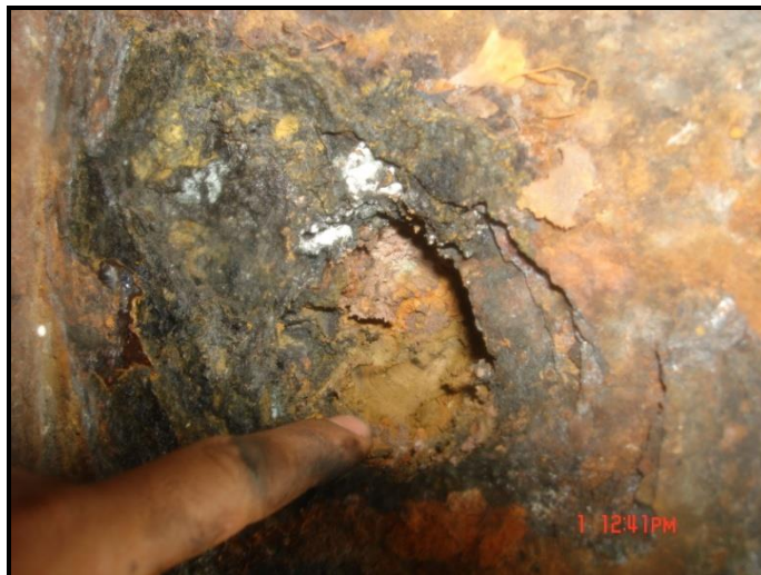
شکل ۵-۱۲- خوردگی کامل سپر در بعضی از نواحی پاشش آب
