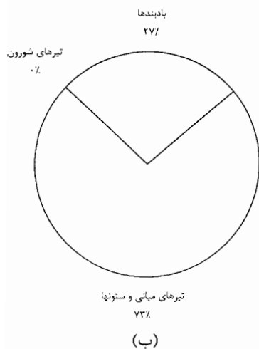
شکل (۶-۷۵) - سهم کار انجام شده در اعضای سازه CHEVRON تحت زمینلرزه El Centro الف) کار نیروی میرایی ب) کار الاستو-پلاستیک
