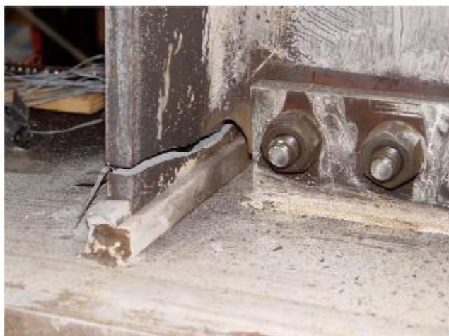
شکل ۳-۹- شکست ترد در نمونه تقویت نشده [۳]
