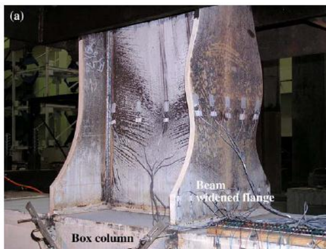
شکل ۳-۲۱- نمونه W10-L1A در انتهای دررفت ۴٪ [۱۰]
