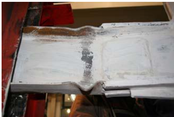
شکل ۳-۲۸- وضعیت نمونه دوم در انتهای آزمایش [۲]
