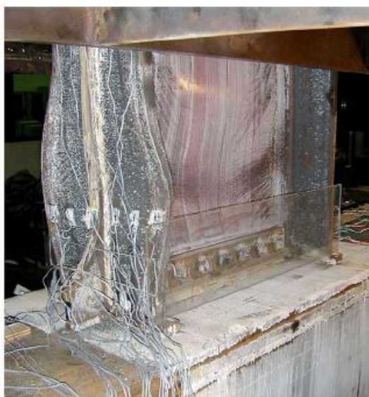
شکل ۳-۱۳- کمانش موضعی جان و بال تیر نمونه BR105SB [۳]
