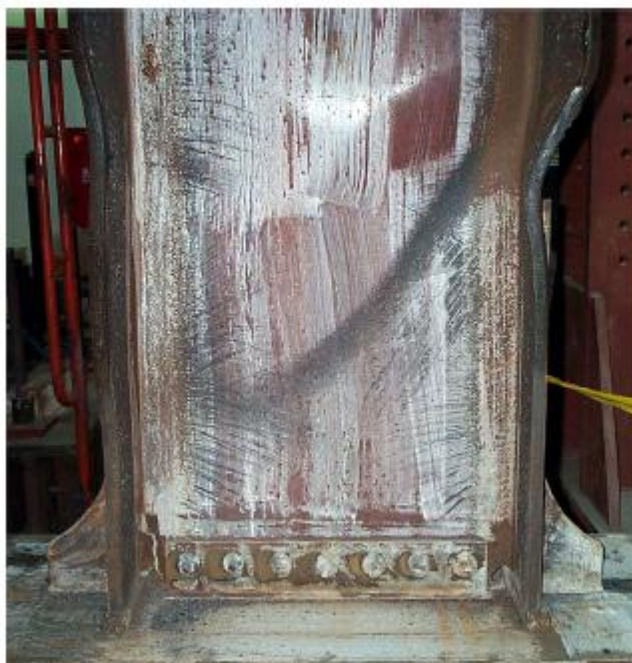
شکل ۳-۱۲- کمانش موضعی جان و بال تیر نمونه BR115SB [۳]
