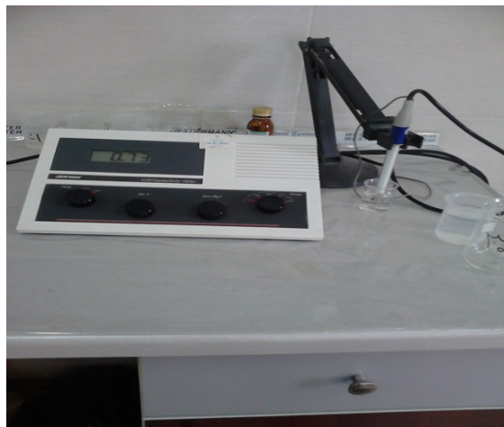
شکل ۳-۱۱: اندازه گیری برخی خصوصیات خاک
