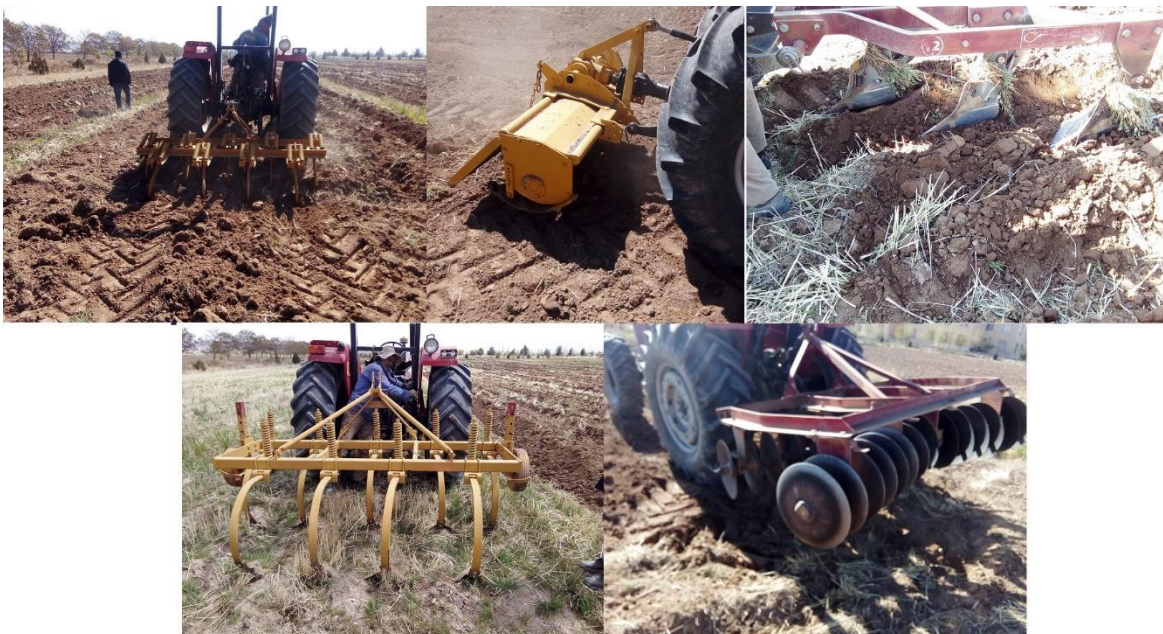
شکل ۳-۲- نمای کلی از ادوات خاکورزی مورد استفاده (از راست به چپ گاواهن برگرداندار، روتیواتور، کولتیواتور، دیسک و چیزل)
