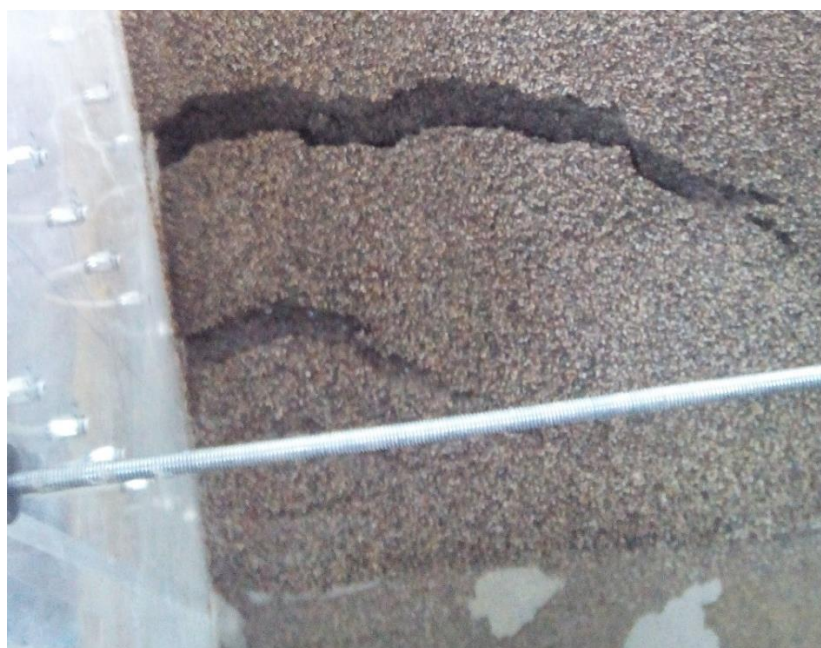
شکل ۴-۱۵ نمایی از گسیختگی شیب ۴۵ درجه با پوشش ۱۰٪ آهک هیدراته
