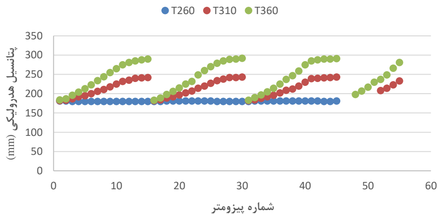
شکل ۲۲-۴ تغییرات پتانسیل هیدرولیکی به ازای تراز آبی مختلف
