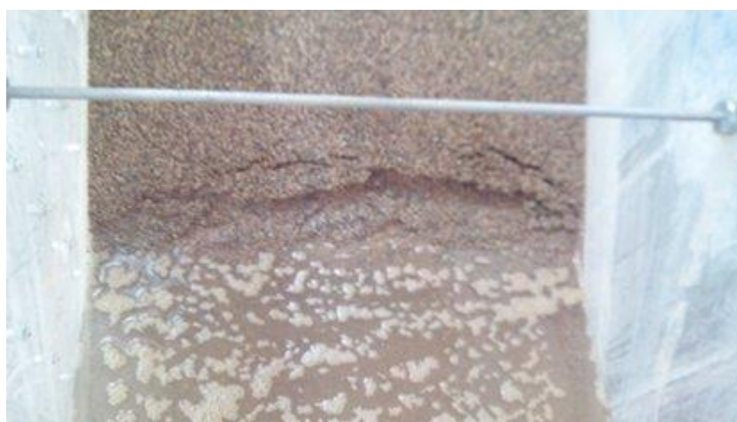
شکل ۴-۲۴ نمایی از گسیختگی شیب معکوس جداره ۵۳ درجه بدون پوشش
