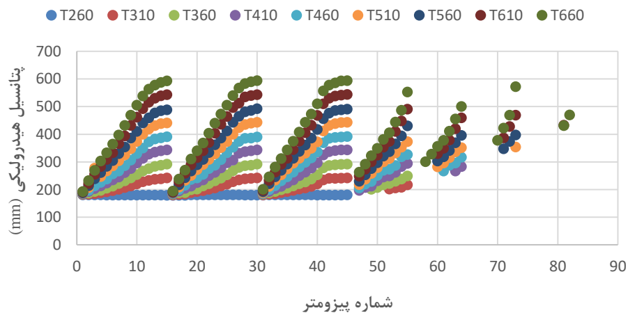
شکل ۴-۳۴ تغییرات پتانسیل هیدرولیکی به ازای تراز آبی مختلف
