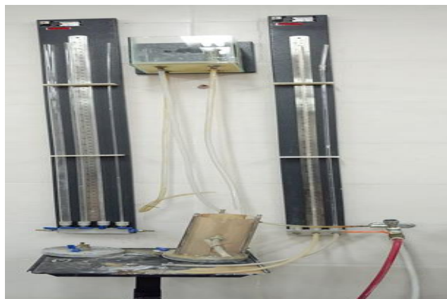
شکل ۳-۳ نمایی از مدل آزمایشگاهی تعیین ضریب نفوذپذیری با بار ثابت
