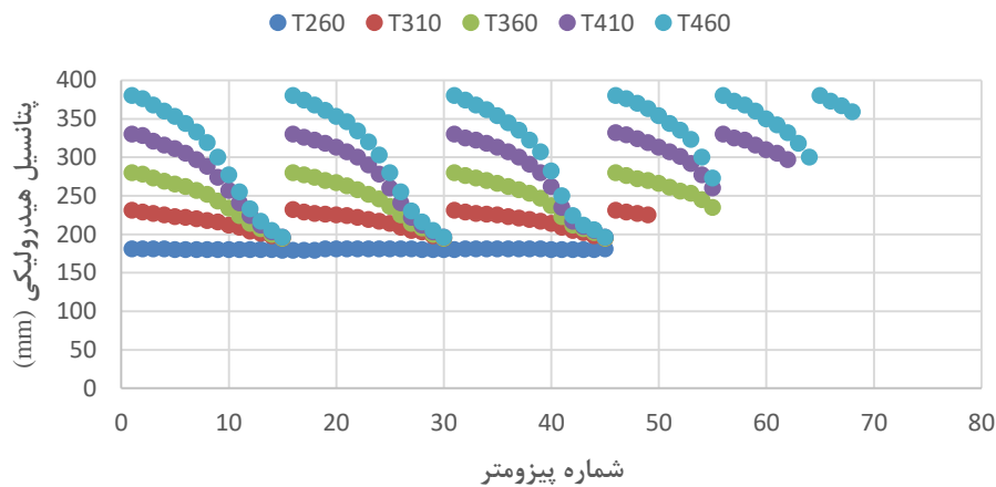
شکل ۴-۳۷ تغییرات پتانسیل هیدرولیکی به ازای تراز آبی مختلف
