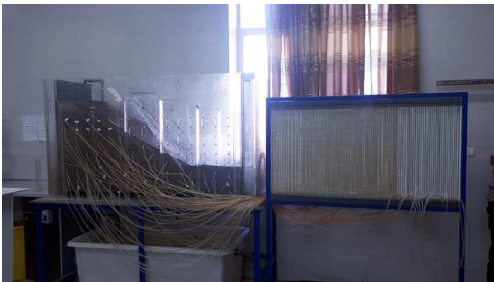
شکل ۱-۳ تصویر مخزن نشت و تابلو پیزومتری مورد استفاده در تحقیق حاضر
