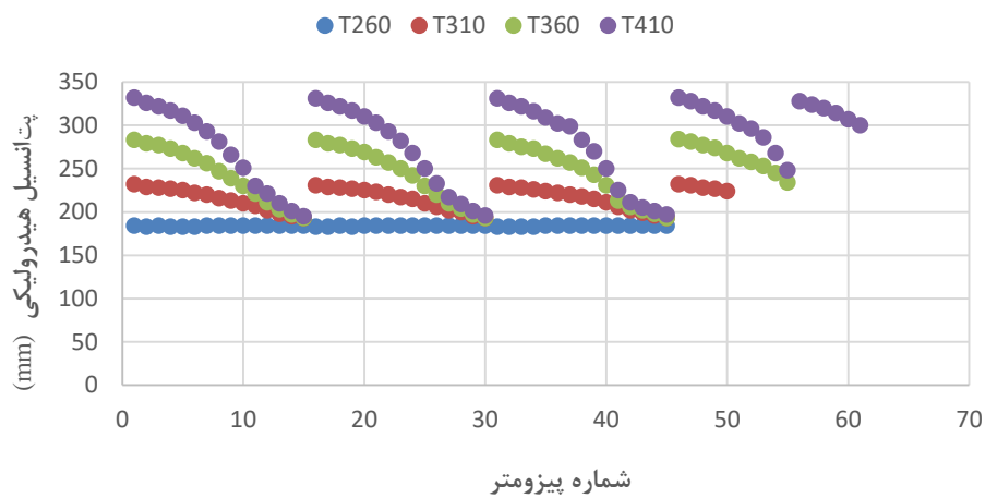
شکل ۴-۲۵ تغییرات پتانسیل هیدرولیکی به ازای تراز آبی مختلف
