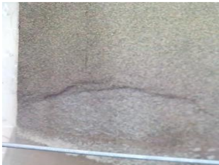
شکل ۴-۲۱ گسیختگی شیب جداره ۵۳ درجه فاقد پوشش
