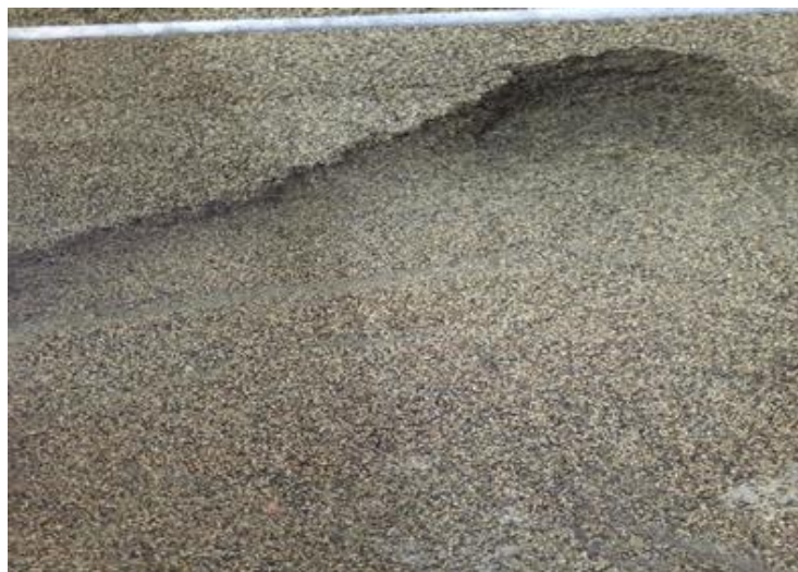
شکل ۴-۳ نمایی از گسیختگی شیب جداره ۴۵ درجه بدون پوشش
