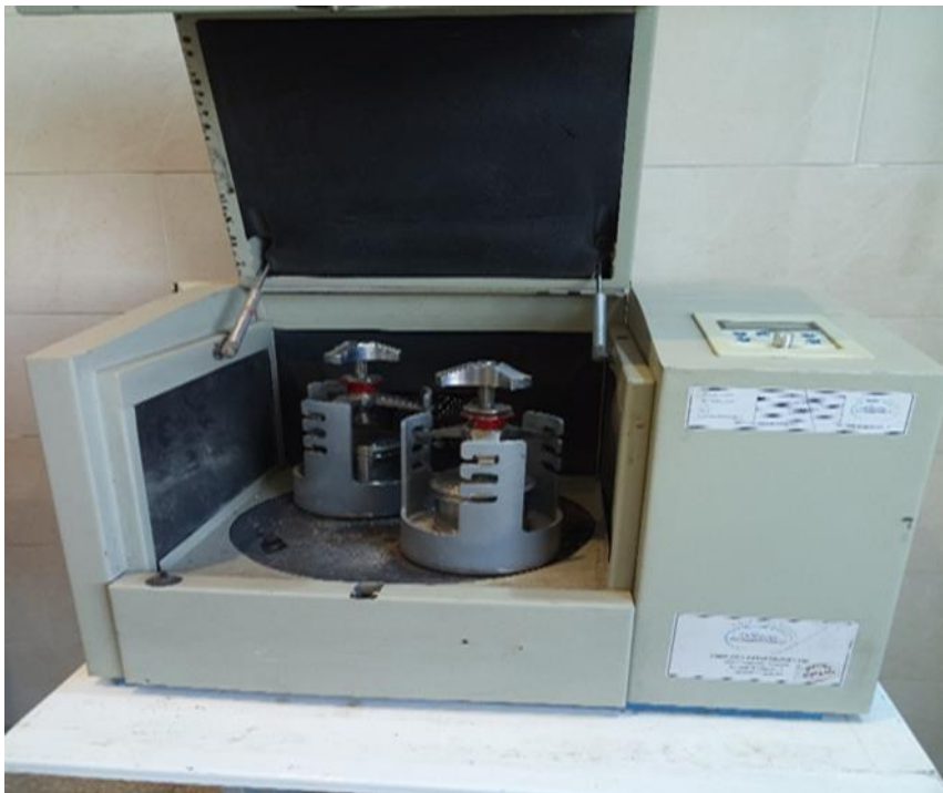
شکل ۳-۴ نمای شماتیک دستگاه آسیاب گلوله‌ای سیاره‌ای
