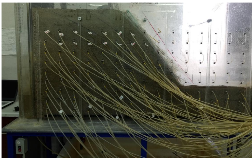
شکل ۴-۴۵ عدم بروز نشانه‌ای گسیختگی در شیب ۴:۳ با پوشش ۵٪ وزنی نانو آهک هیدراته
