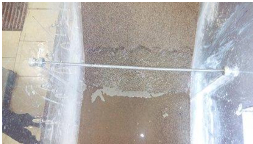
شکل ۴-۶ نمایی از گسیختگی شیب معکوس جداره ۴۵ درجه بدون پوشش
