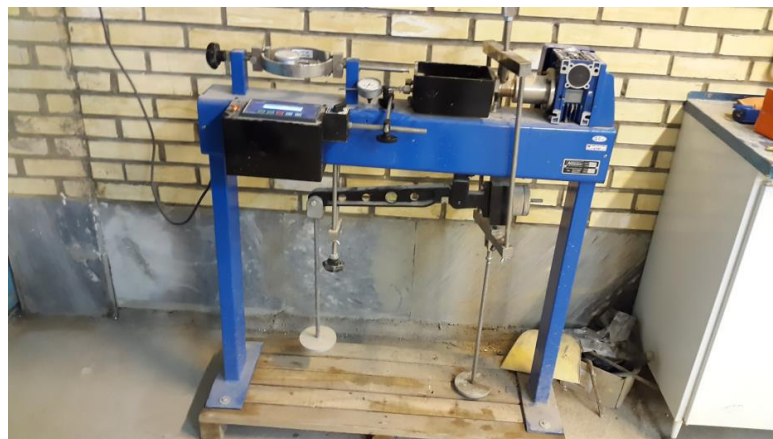
شکل ۳-۸ نمای شماتیک دستگاه برش مستقیم
