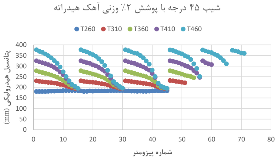
شکل ۴-۷ تغییرات پتانسیل هیدرولیکی به ازای تراز آبی مختلف
