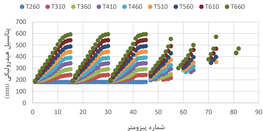
شکل ۴-۴۳ تغییرات پتانسیل هیدرولیکی به ازای تراز آبی مختلف
