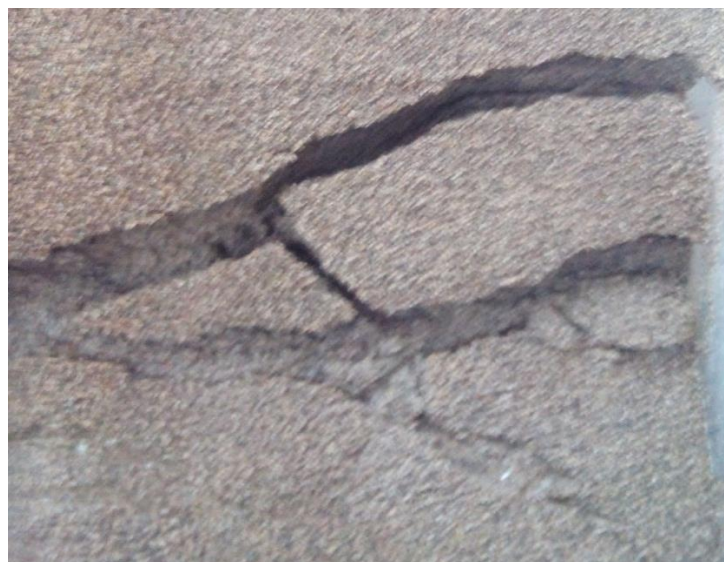
شکل ۴-۱۲ نمایی از گسیختگی شیب ۴۵ درجه با پوشش ۵٪ وزنی آهک هیدرات
