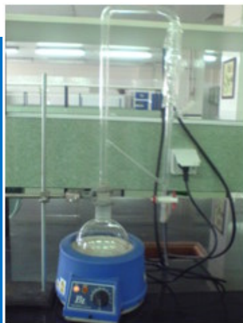
شکل ۱-۳ دستگاه اسانس گیر برای مایعات فرارسیک تر از آب.
