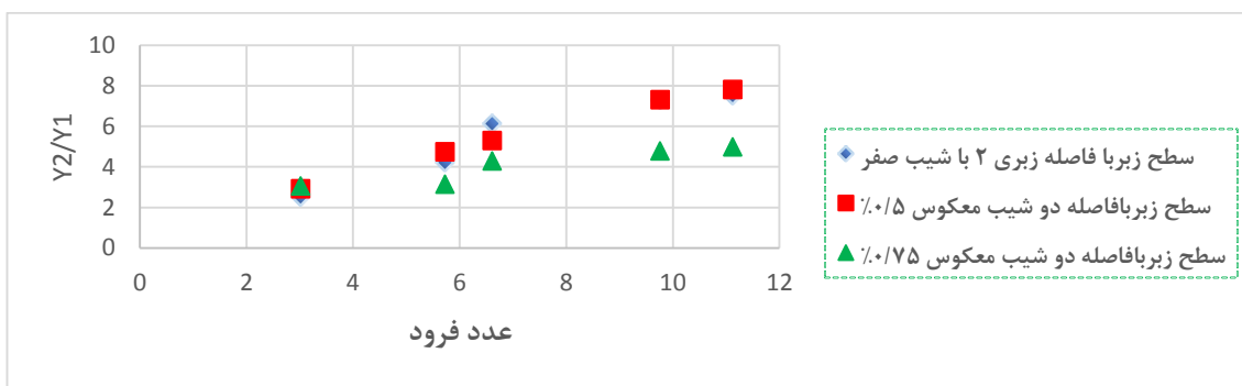
شکل ( ۴-۱۳) بررسی اعماق پرش در برابر عدد فرود با اعمال شیب معکوس (زبری ۲)
