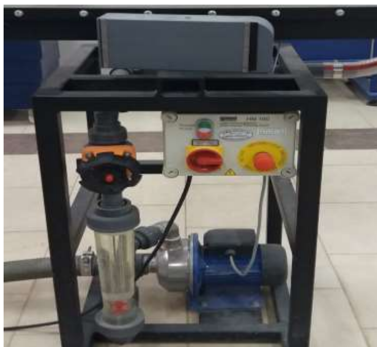
شکل (۳-۱) سیستم پمپاژ و کنترل دبی
