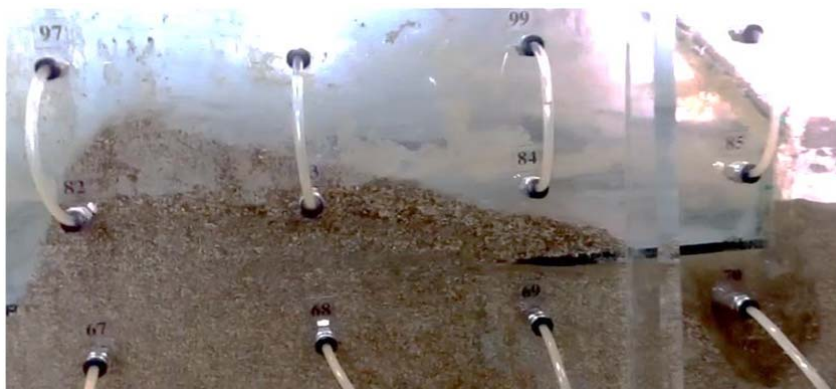
شکل ۳-۱۰- نمایی از تخریب پی در پایین دست سد بر اثر پدیده زیرشویی
