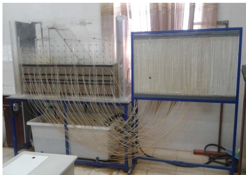
شکل ۳-۷- مخزن نشت و تابلو پیزومتری استفاده شده برای آزمایش های مختلف
