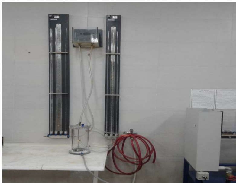
شکل ۳-۶- نمایی از مدل آزمایشگاهی ضریب نفوذپذیری با بار ثابت
