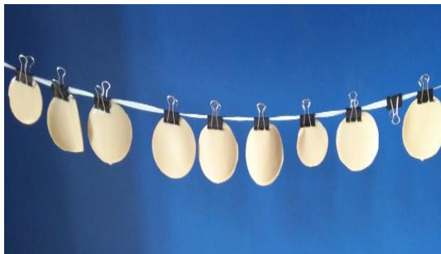
شکل (۳-۳): پوشش‌دهی با محلول نانوذرات دی‌اکسید تیتانیوم و موم کارنوبا
