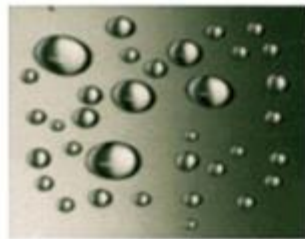
الف: قبل از تابش نور بر سطح دی اکسید تیتانیوم (ایجاد قطره)
