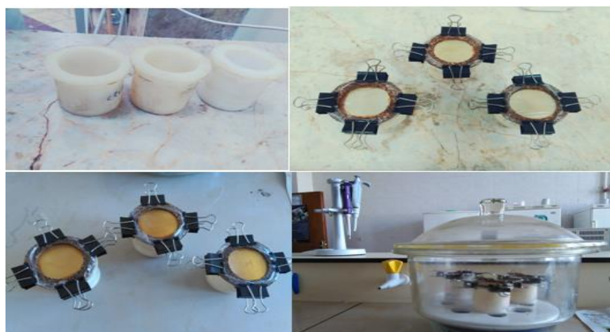
شکل (۳-۵): تست نفوذپذیری به بخار آب
