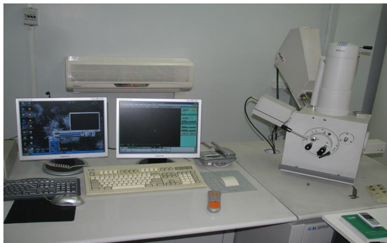
شکل (۳-۱۰): دستگاه میکروسکوپ الکترونی روبشی
