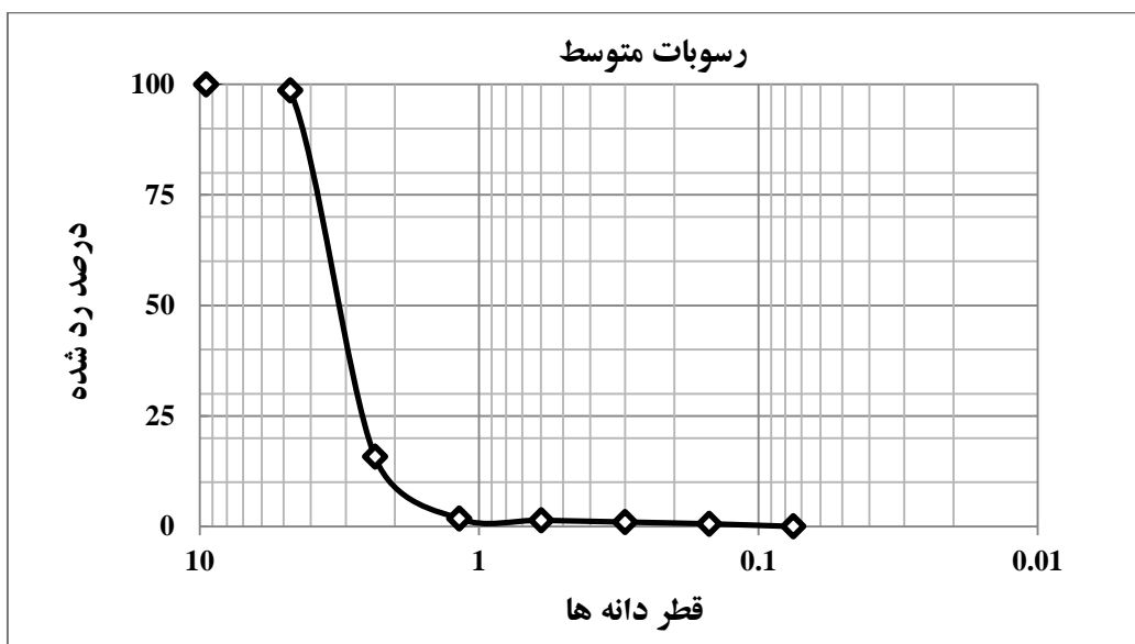
شکل ۳-۶- نمودار دانه‌بندی رسوبات با قطر متوسط ۳/۲ میلی‌متر
