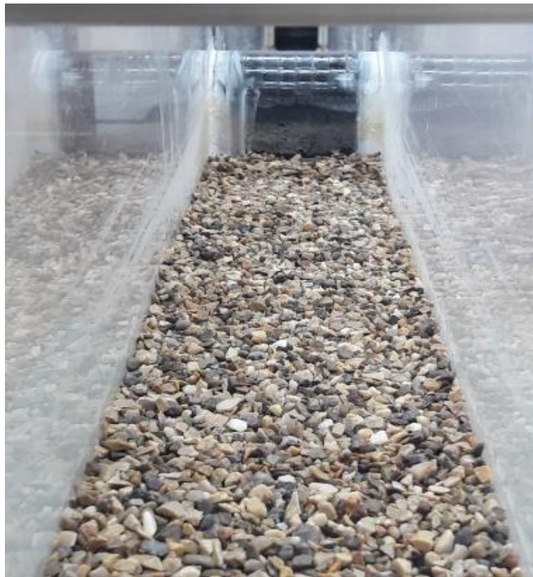
شکل ۳-۱۲- توزیع رسوبات درون فلوم
