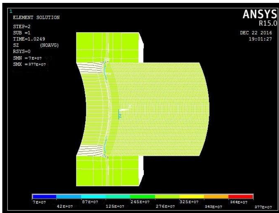
شکل ۴-۱۲- نمای بالایی کانتور تنش عمودی در راستای محور Z
