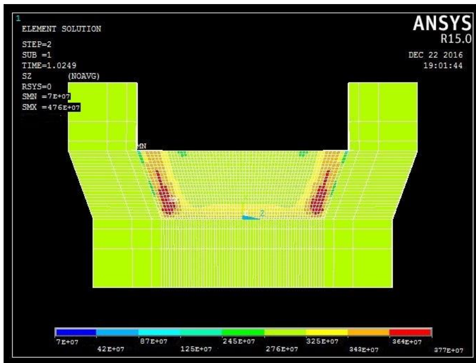
شکل ۴-۱۱- کانتور تنش عمودی در راستای محور Z
